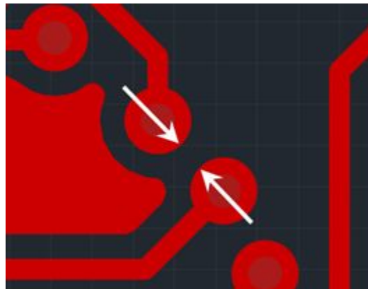
Рис. 506 Зазор между переходным отверстием и другим переходным отверстием
