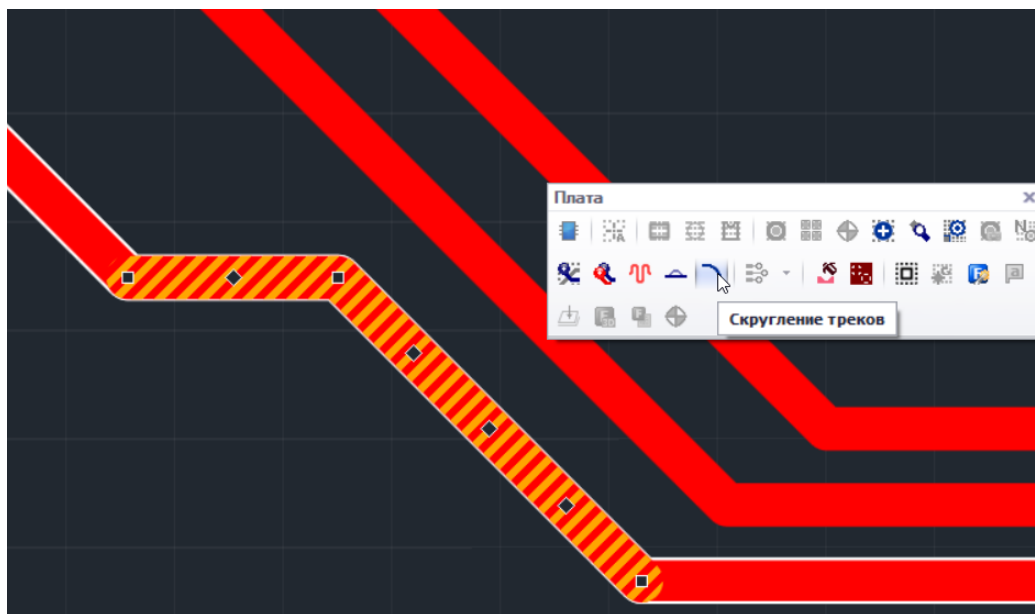
Рис. 255 Применение инструмента к выбранным сегментам
