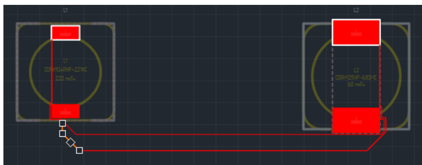
Рис. 315 Ручное изменение ширины зазора между треками
