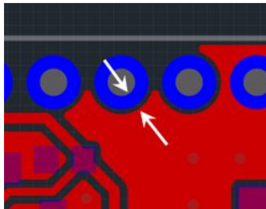
Рис. 514 Зазор между областью металлизации и любым отверстием
