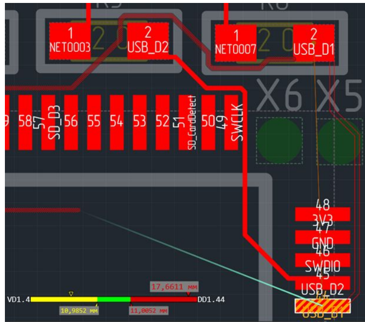
Рис. 343 Вид индикатора при включенной опции «Вычислять оптимальный трек при трассировке»
