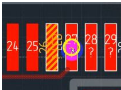
Рис. 287 Отображение на плате контактных площадок, принадлежащих одной группе
