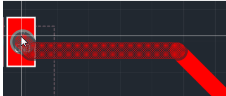
Рис. 230 Вариант нового подключения к контактной площадке
