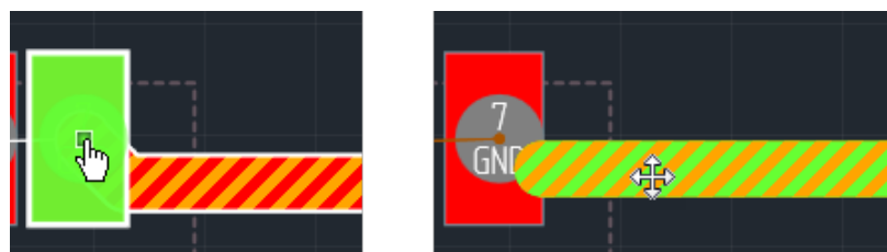
Рис. 229 Редактирование подключения к контактной
