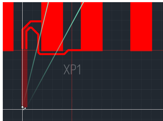
Рис. 300 Зафиксированный участок диффпары и возможный вид следующего участка
