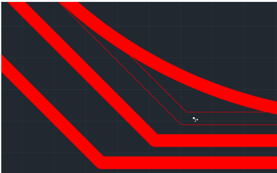
Рис. 250 Отображение (допустимого) скругления вершины трека
