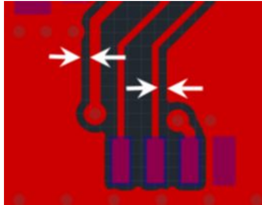
Рис. 499 Зазор между треком и областью металлизации
