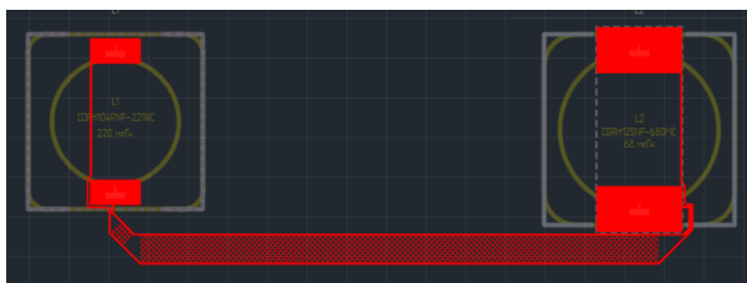
Рис. 317 Дифференциальная пара с измененным зазором между треками пары
