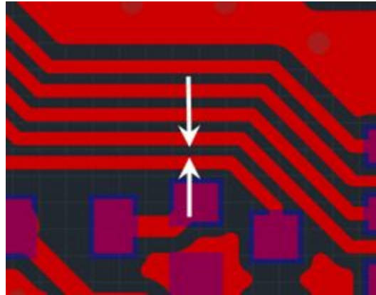
Рис. 495 Зазор между треками
