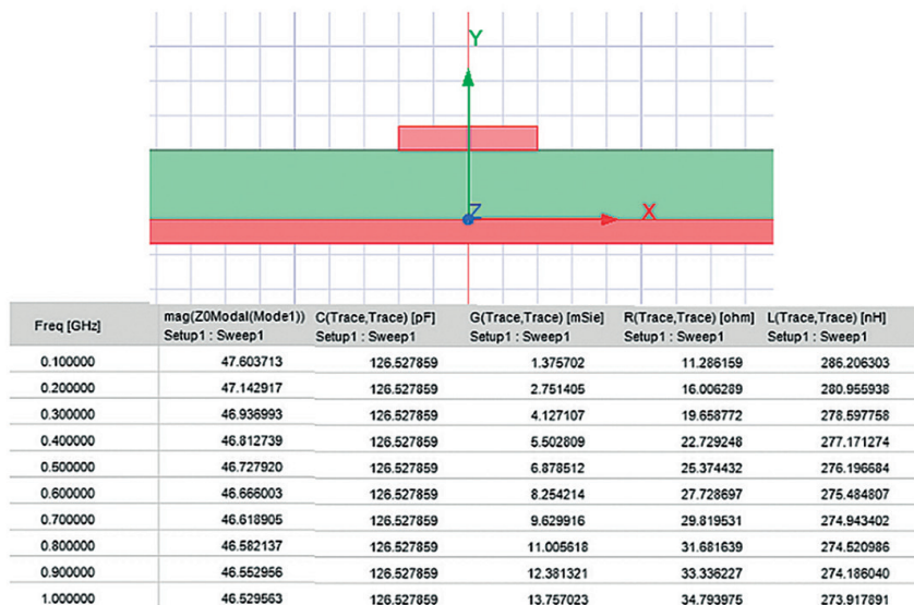
Рис. 5. Модель линии и результаты вычислений в Ansys 2D Extractor
