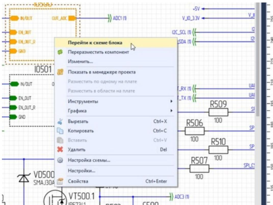
**В САПР Delta Design 3.0 beta появился удобный функционал работы с встроенными блоками - устройствами или функциональными группами, не имеющими самостоятельной принципиальной схемы.**
