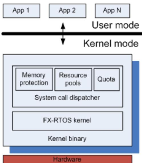
Модуль приложения содержит одну или более нитей, выполняющихся в непривилегированном режиме процессора. Возможна также загрузка более чем одного модуля приложения.
