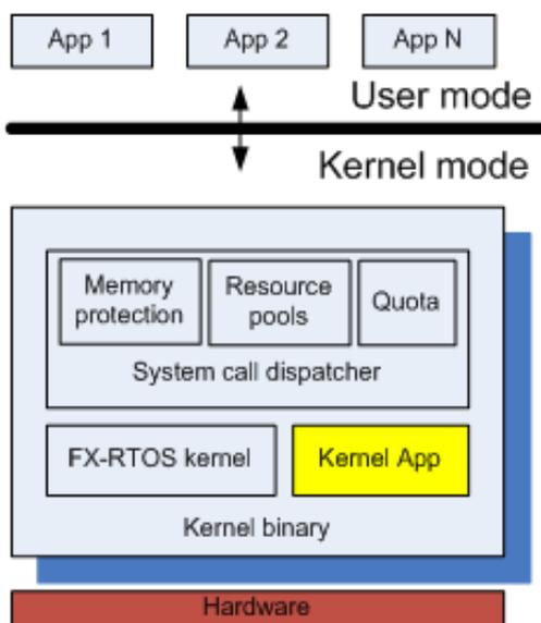
Прикладной интерфейс FX-RTOS остается неизменным как для привилегированных, так и для непривилегированных приложений (в непривилегированном режиме используется подмножество основного API). Таким образом, одно и то же приложение может использоваться по-разному на разных устройствах без внесения в него изменений.
