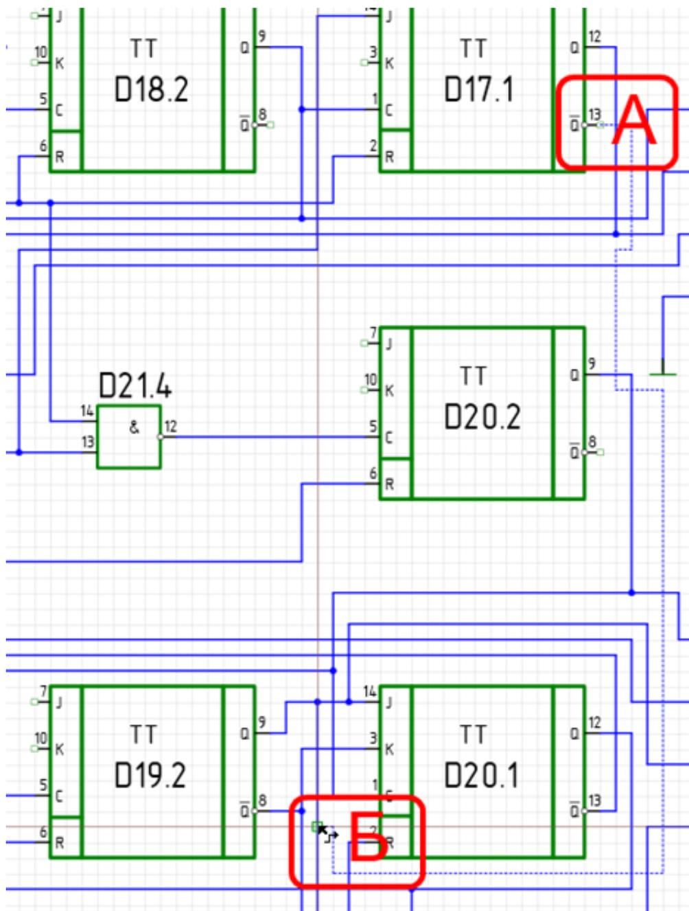
Подключенный компонент может быть перемещен по схеме без разрыва цепей, к которым он подключен.
