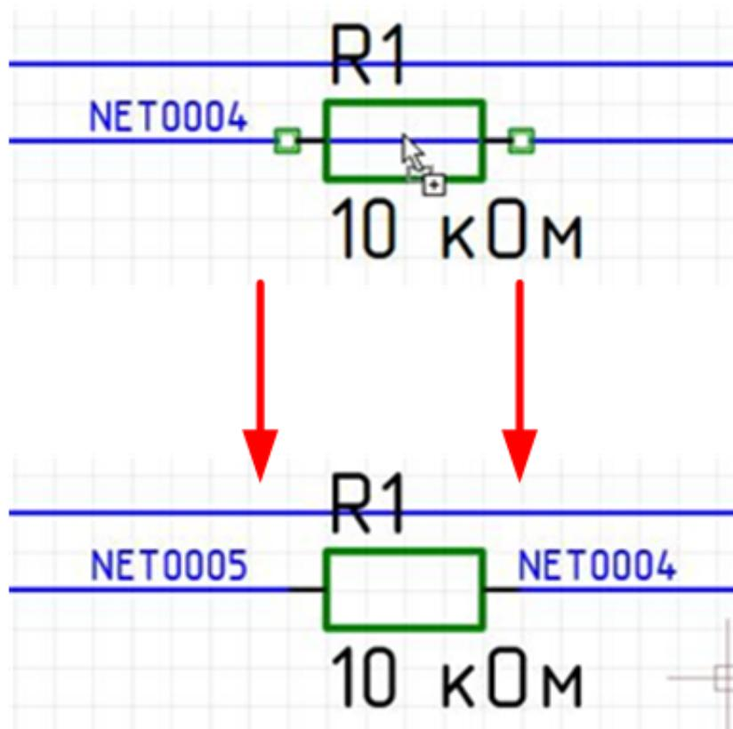
Копирование и вставка элементов схемы происходит с сохранением структуры схемы.
