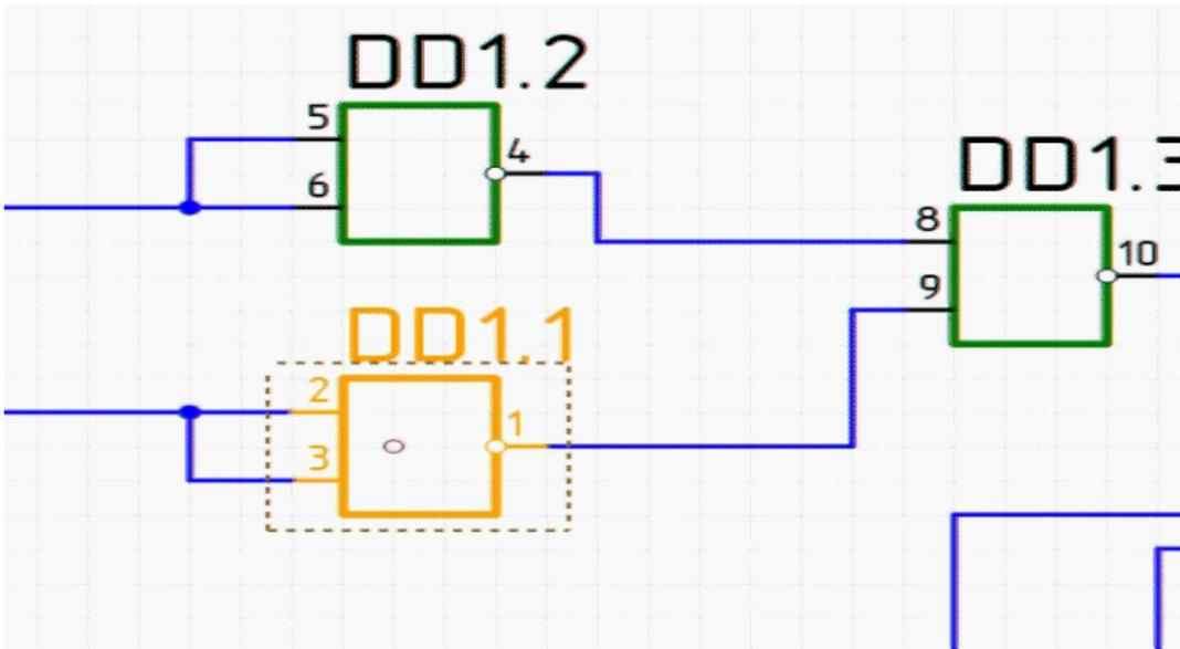
Размещение двухконтактного компонента может производиться с разрывом существующей цепи.
