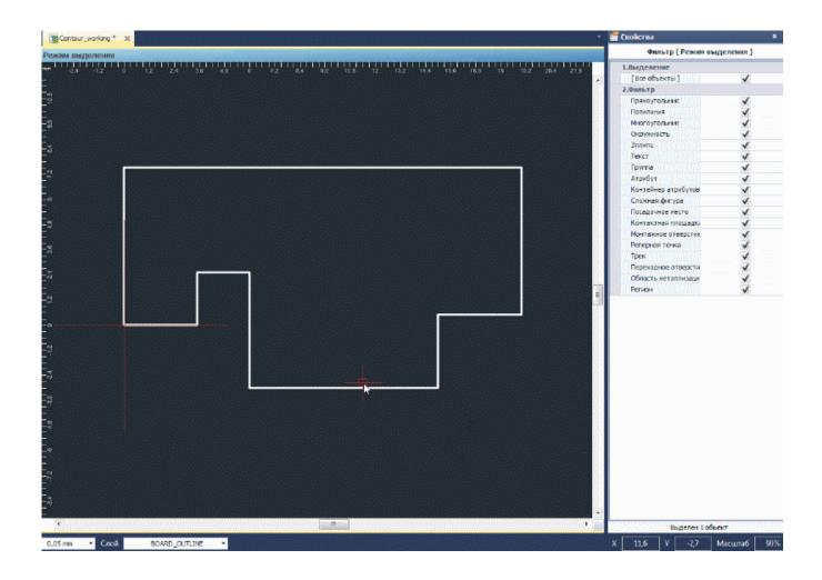
Описание контура платы может быть также передано в систему TopoR через интерфейс обмена проектными данными между этими системами.
