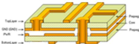
Структура слоев печатной платы включает два слоя разводки соединений и слои подключения земли и питания. Сквозные и "слепые" металлизированные переходные отверстия обеспечивают межслойную коммутацию соединений.
