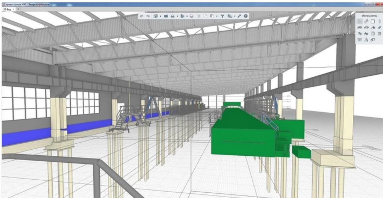
*АО «Саратовстройстекло» проектируют оборудование в КОМПАС-3D, затем размещают его в информационной модели с помощью BIM-системы Renga.*
