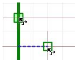
Рис. 159 Точки подключения к шине
