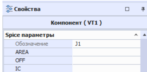
Рис. 39 Общие входные редактируемые SPICE-параметры компонента
