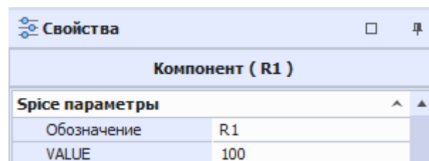
Рис. 85 Редактируемый SPICE-параметр VALUE
