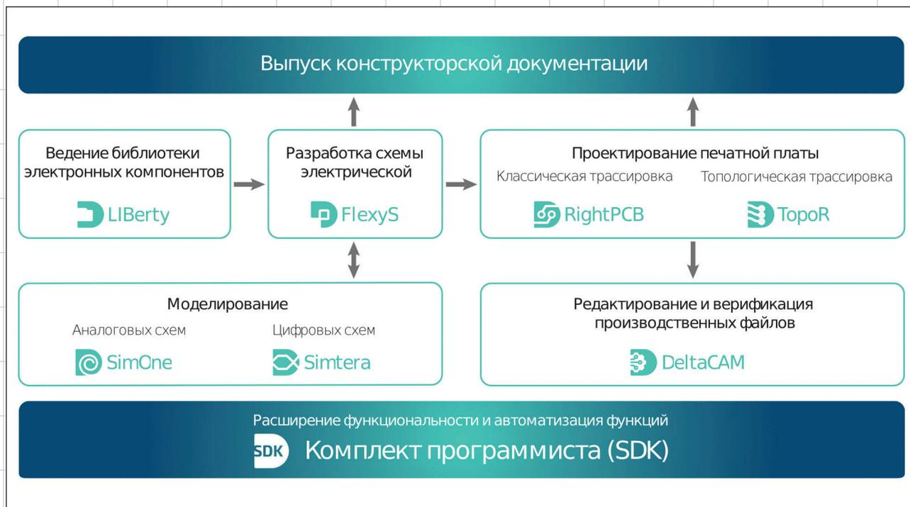
Рис. 1. Блок-схема системы Delta Design
