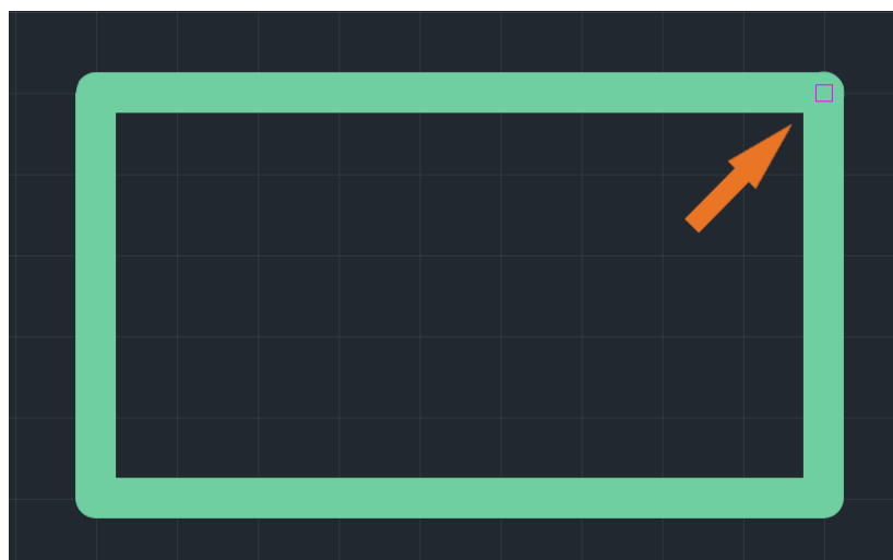
Рис. 232 Привязка к вершине прямоугольника
