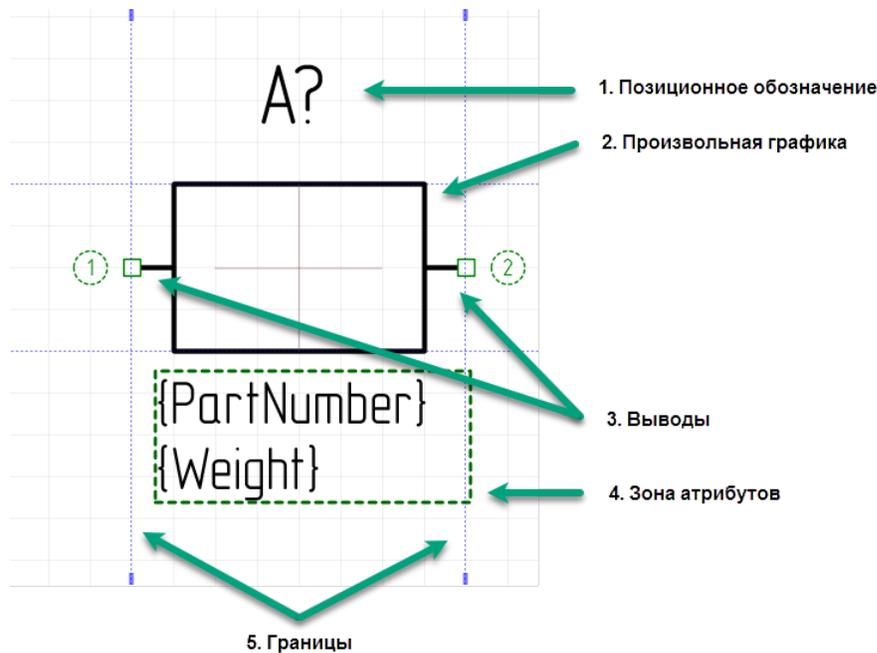
Рис. 176 Структурные элементы УГО
