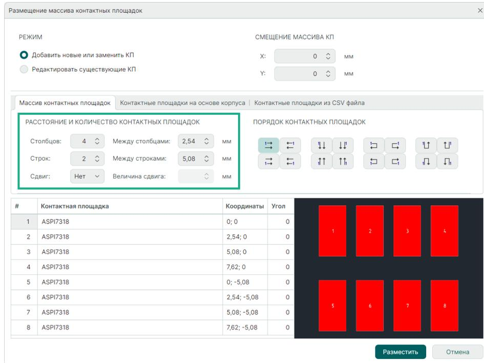
Рис. 96 Геометрические параметры массива контактных площадок
