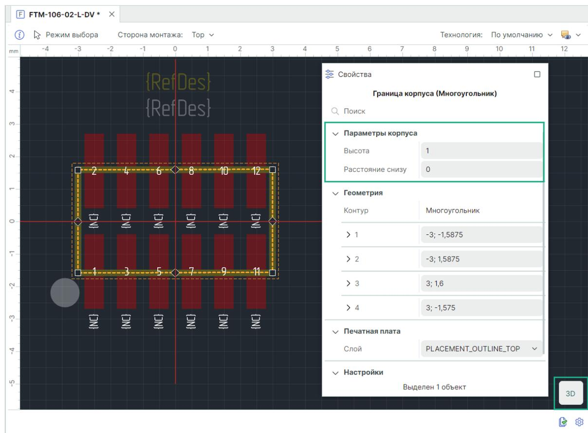
Рис. 163 Создание 3D модели посадочного места
