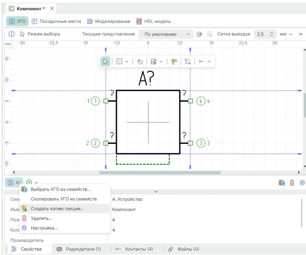
Рис. 215 Вызов инструмента копирования секции
