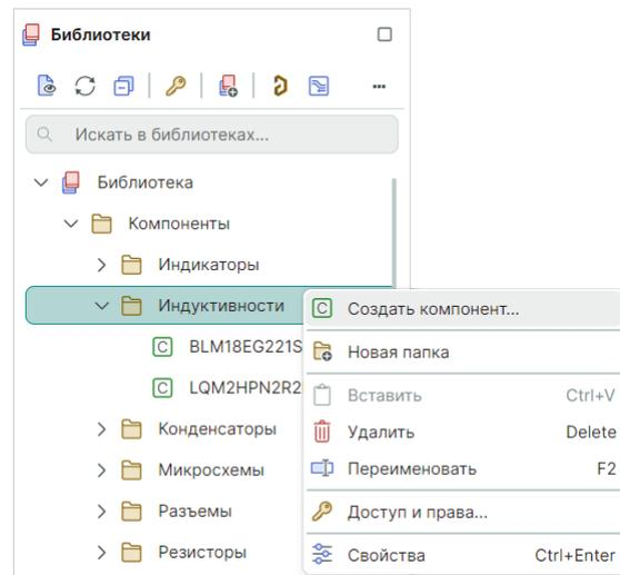
Рис. 201б Создание компонента с выбором семейства устройства
