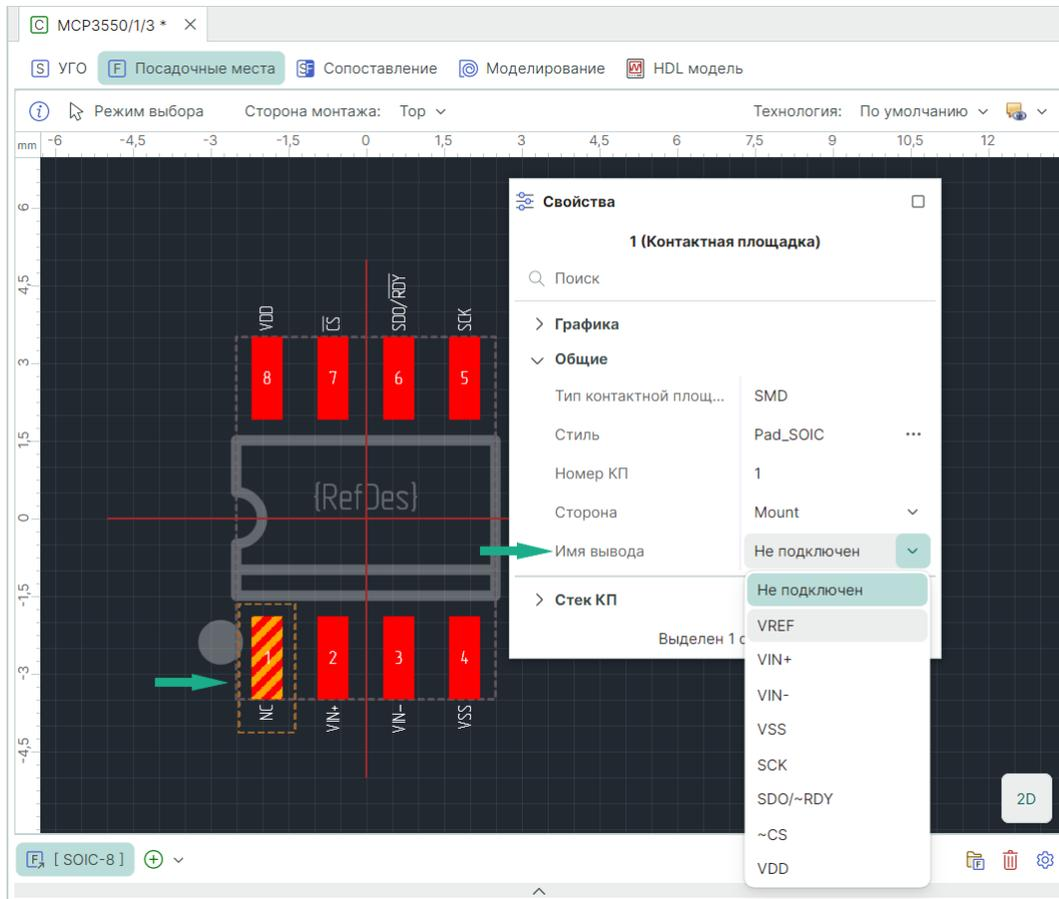
Рис. 288 Сопоставление КП через панель «Свойства»
