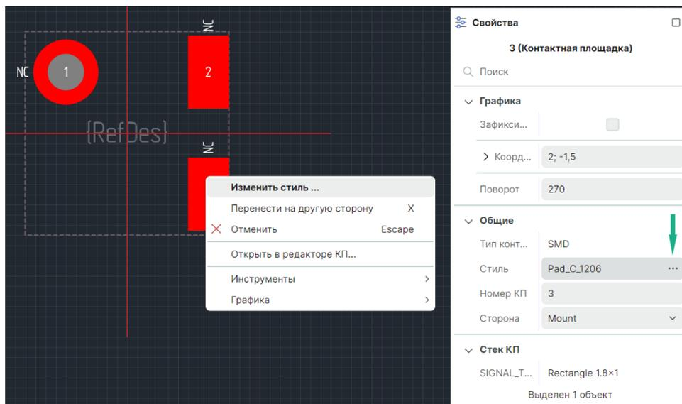
Рис. 92 Изменение типа и/или стиля размещаемой контактной площадки
