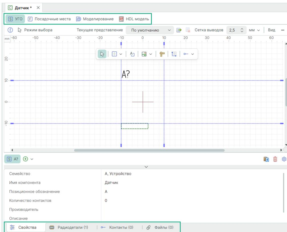
Рис. 206 Вкладки окна редактора компонентов
