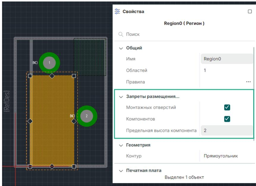
Рис. 137 Установка запрета на размещение МО и компонентов
