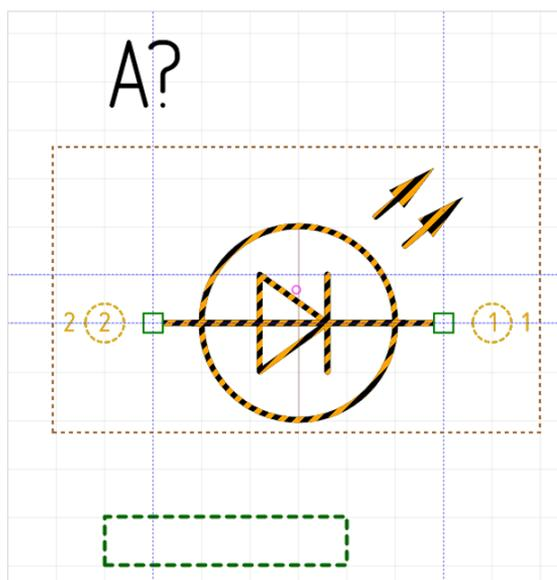
Рис. 214 Размещение скопированного УГО
