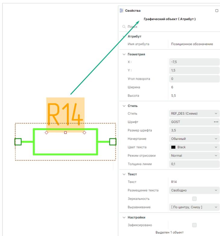
Рис. 179 Свойства позиционного обозначения
