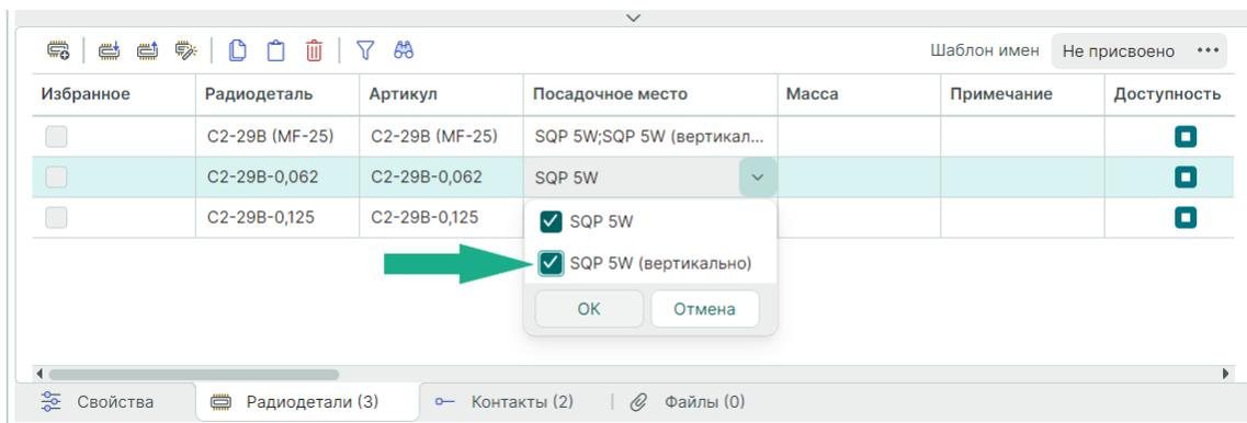
Рис. 328 Выбор посадочных мест для радиодетали
