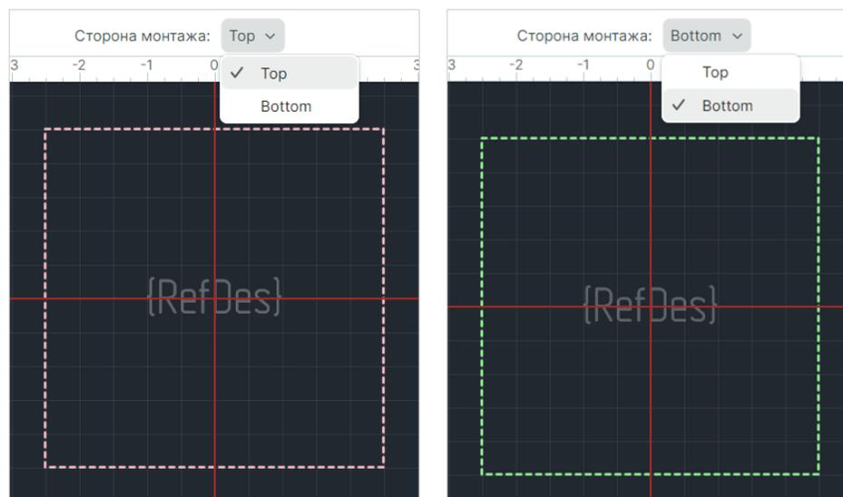
Рис. 122 Переключение стороны просмотра посадочного места
