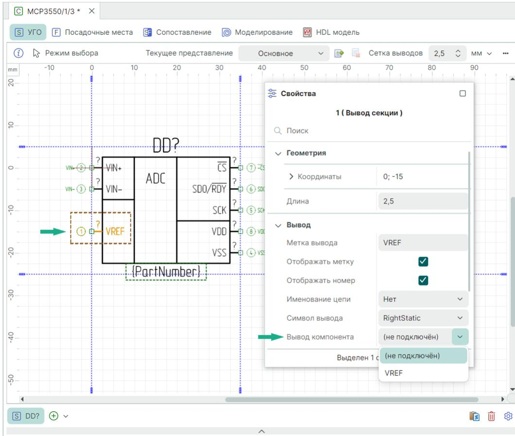
Рис. 286 Сопоставление вывода через панель «Свойства»
