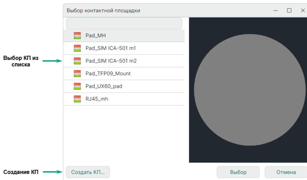
Рис. 110 Выбор типа размещаемого монтажного отверстия
