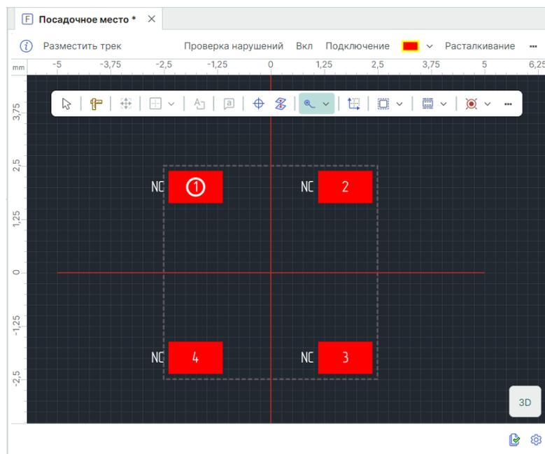
Рис. 111 Контактная площадка, доступная для начала размещения трека
