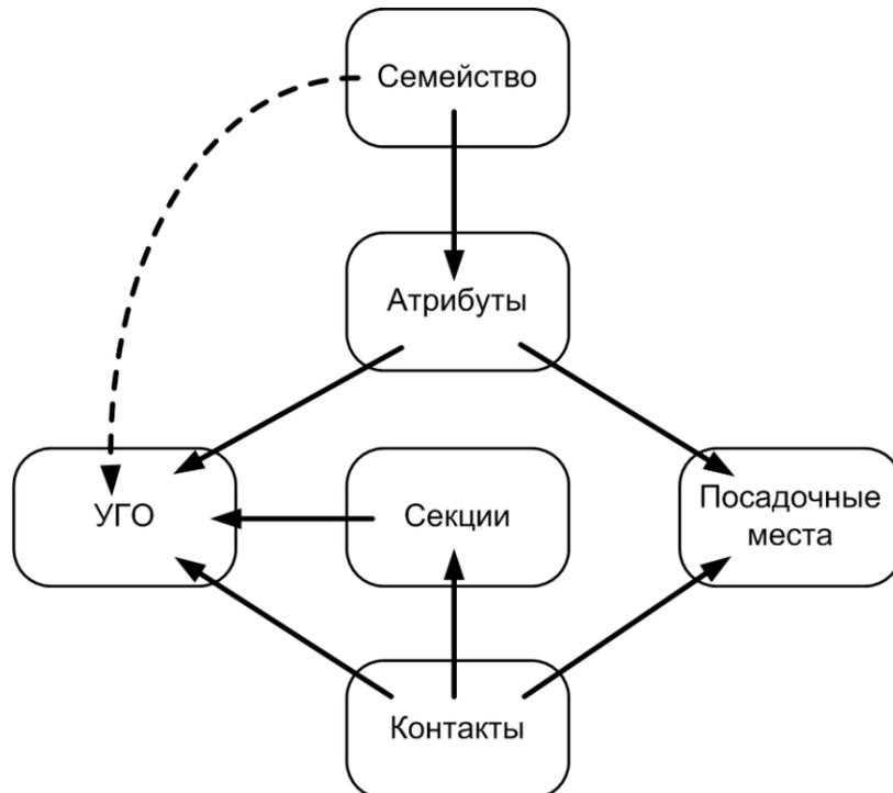
Рис. 1 Структурная схема описания компонента в Delta Design
