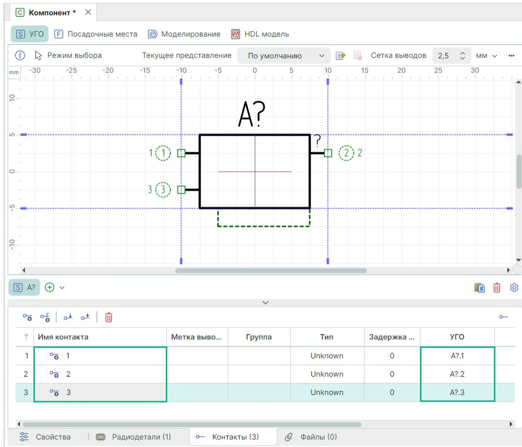
Рис. 243 Размещенный вывод сопоставлен с контактом
