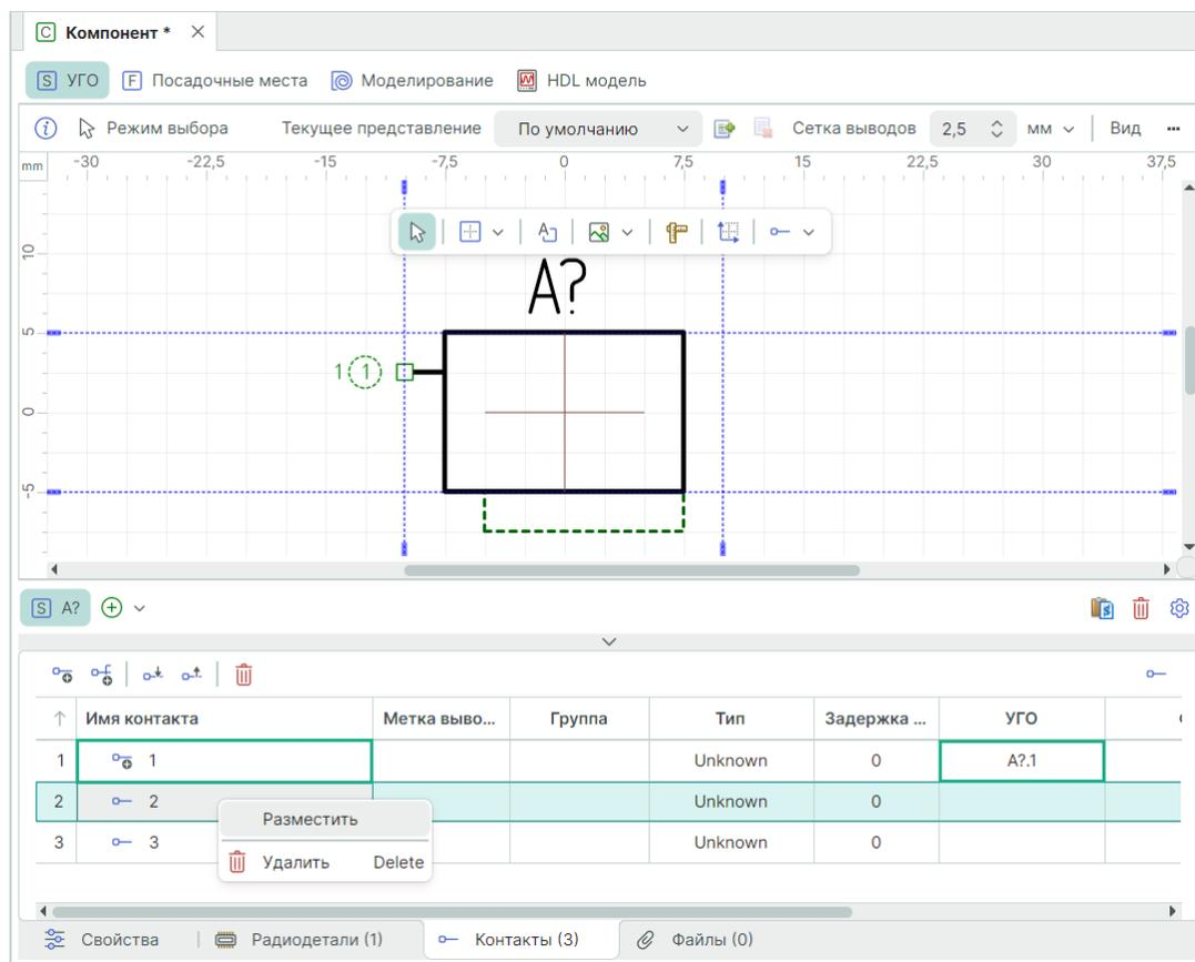
Рис. 241 Размещение выводов на основе контактов
