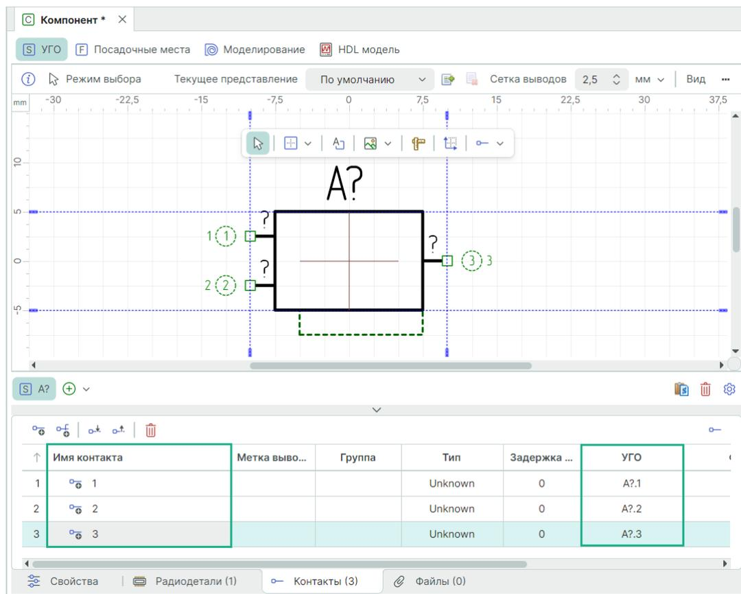
Рис. 239 Сопоставление вывода с автоматически созданным контактом
