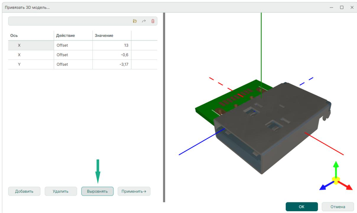
Рис. 168 Действия для выравнивания 3D модели
