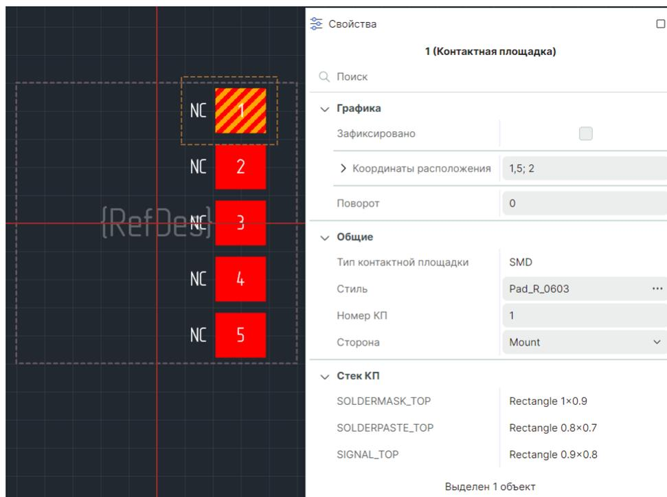
Рис. 123 Свойства контактной площадки
