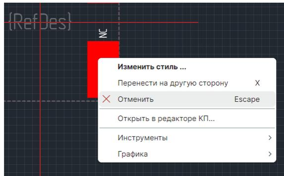
Рис. 91 Выход из инструмента «Разместить контактную площадку»
