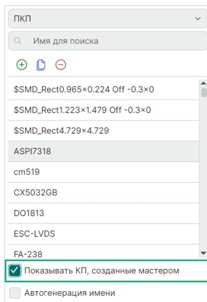
*Рис. 68 Доступ к контактным площадкам, созданным автоматически*
