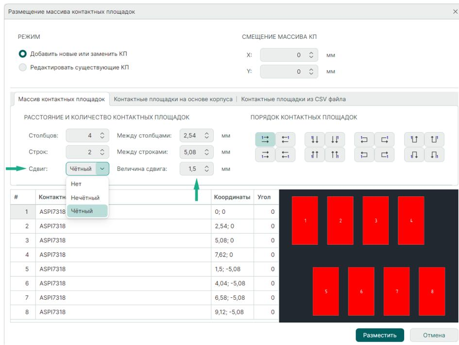
Рис. 97 Установка сдвига для контактных площадок
