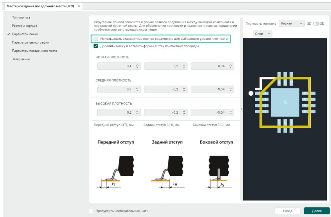
Рис. 156 Определение параметров контактных площадок
