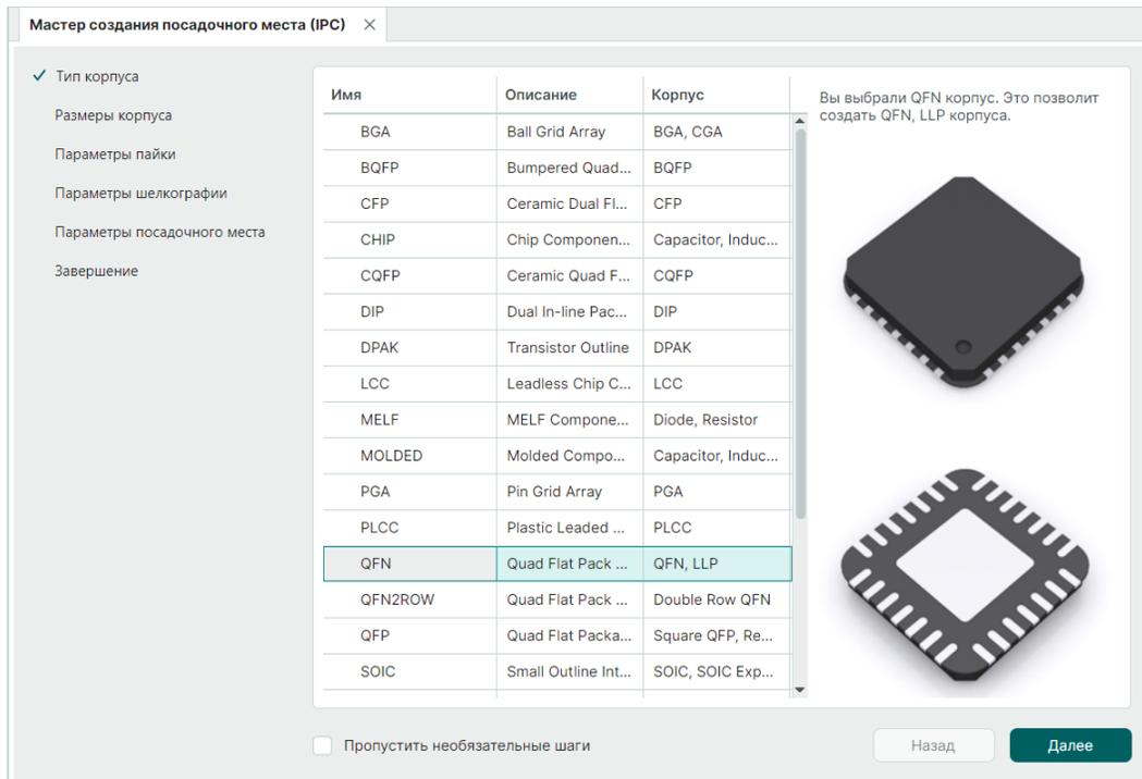
Рис. 154 Выбор корпуса для создания посадочного места
