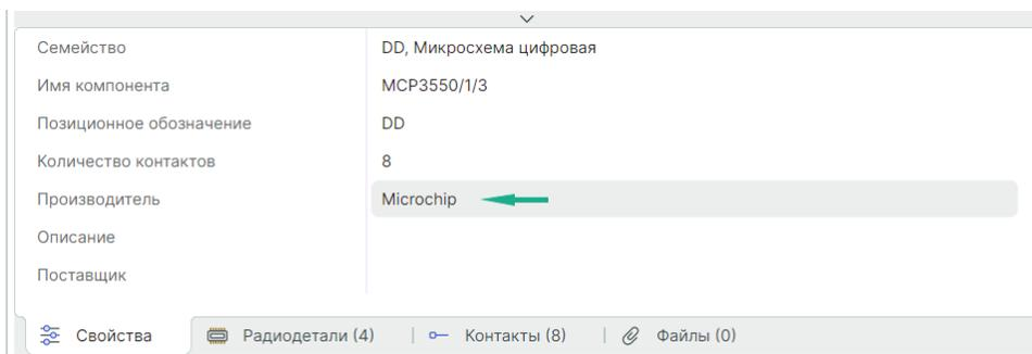
Рис. 310 Изменение производителя компонента
