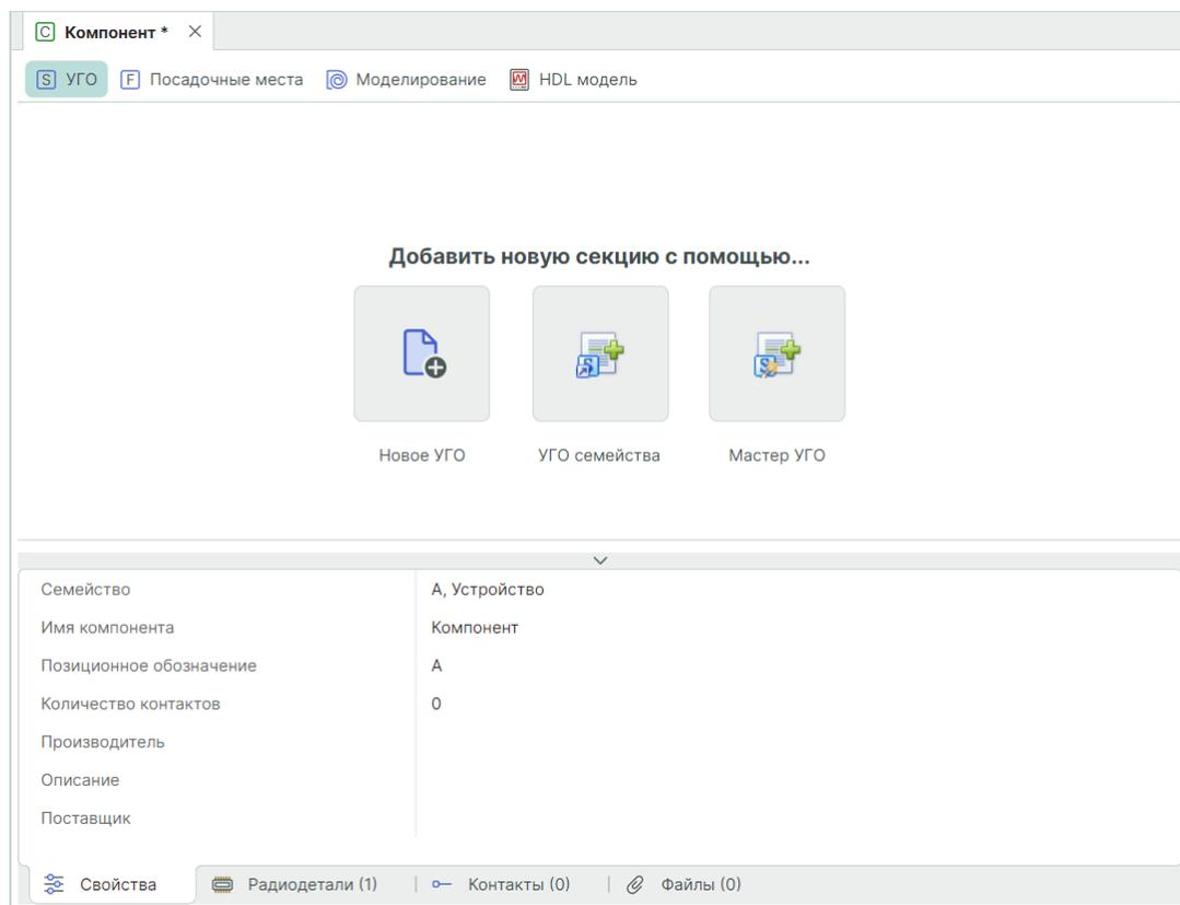
Рис. 224 Создание секций, если у компонента все секции ранее были удалены
