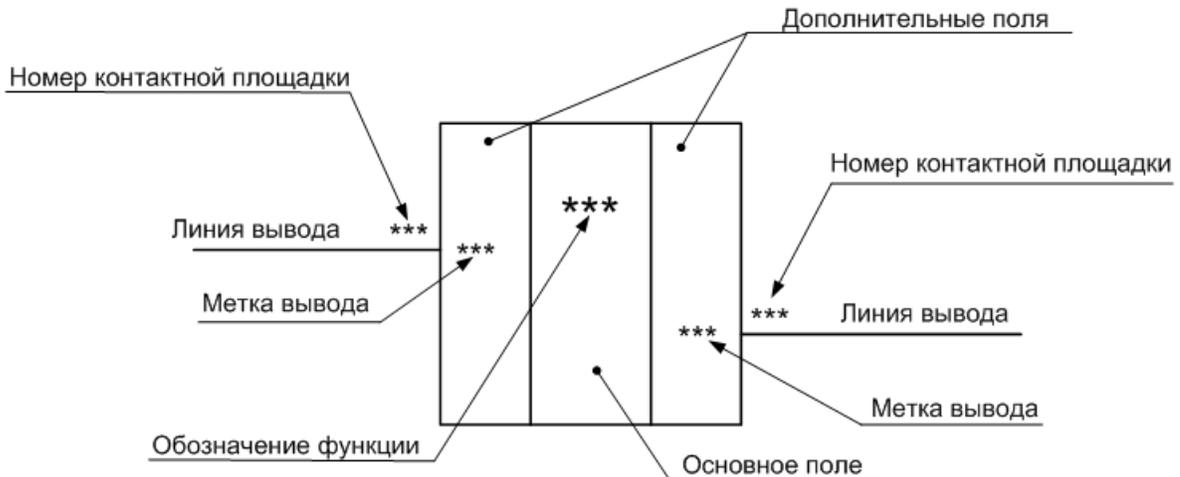
Рис. 231 Типовое УГО элемента цифровой техники
