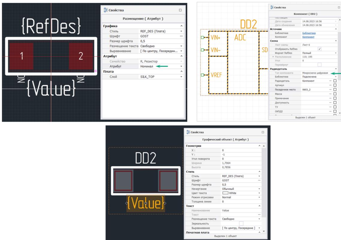
Рис. 118 Результат назначения атрибутов разных семейств в посадочном месте и в компоненте
