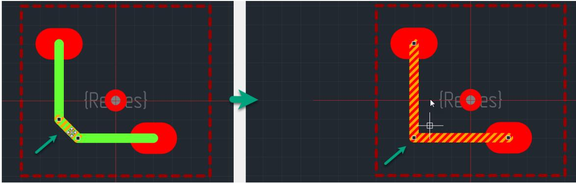
Рис. 130 Сегмент «удален» при совмещении соседних сегментов
