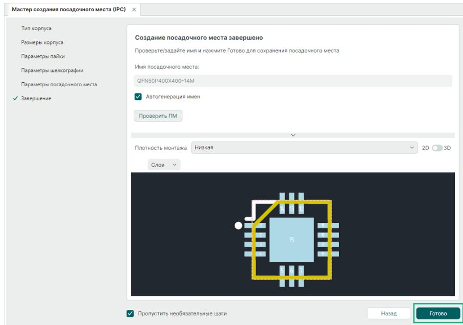
Рис. 161 Завершение создания посадочного места
