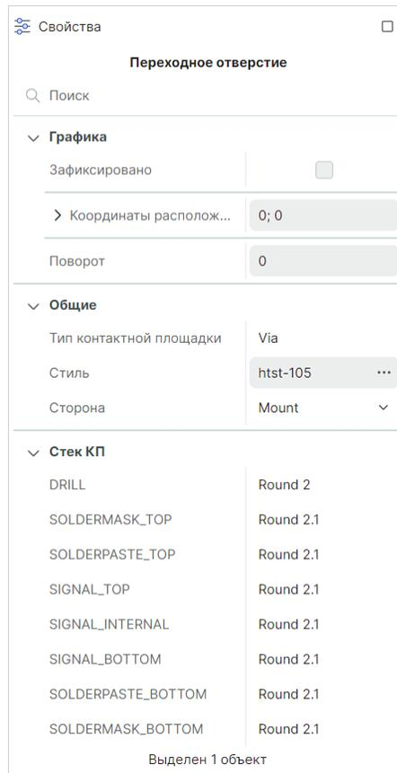
Рис. 136 Свойства переходного отверстия
