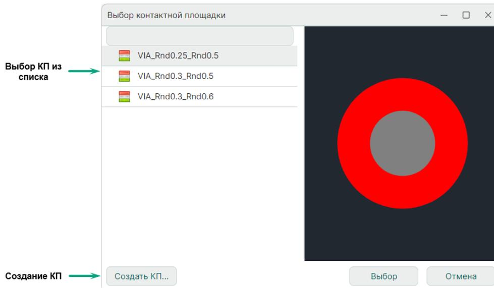
Рис. 112 Выбор типа размещаемого переходного отверстия
