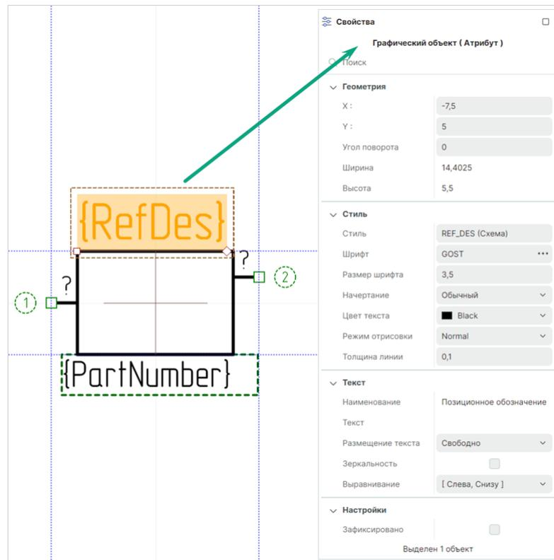
Рис. 187 Настройка свойств позиционного обозначения
