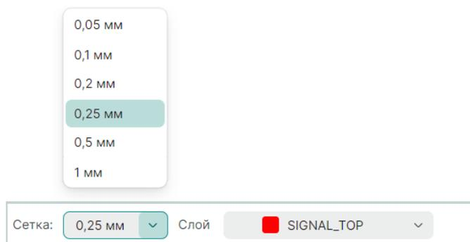
Рис. 90 Установка произвольного шага графической сетки
