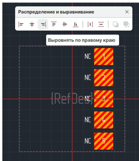
Рис. 124 Инструменты распределения и выравнивания
