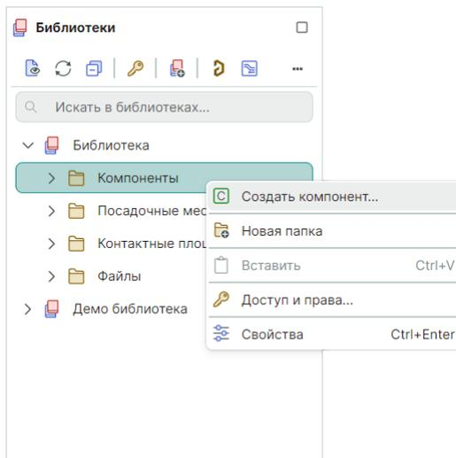
Рис. 201а Создание компонента без выбора семейства устройства
