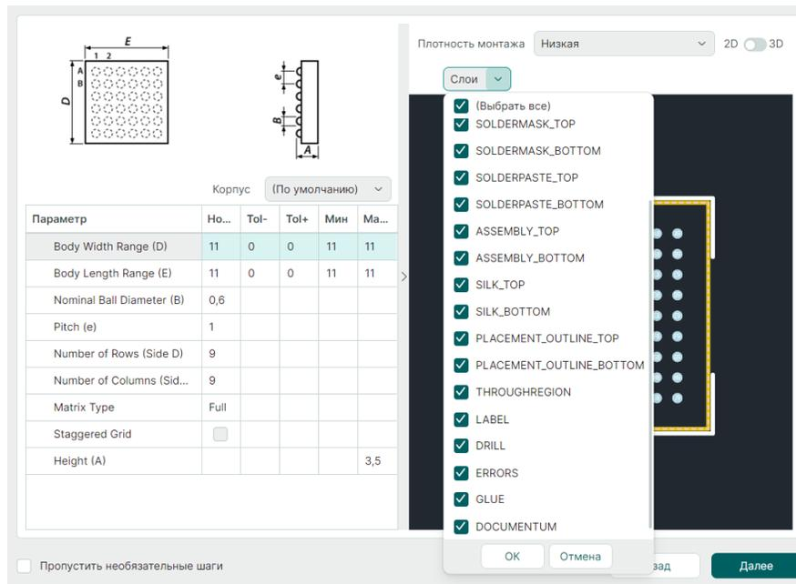
Рис. 153 Выбор плотности монтажа и классов слоев для отображения
