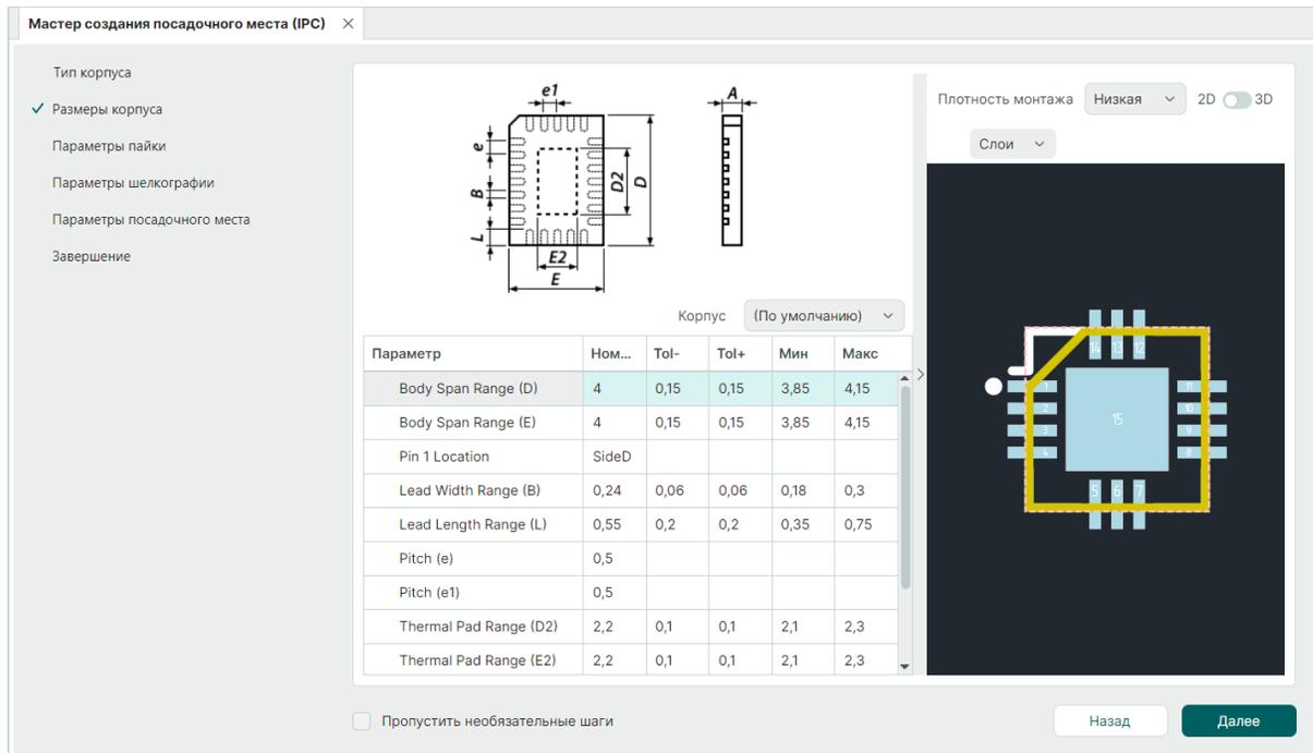
Рис. 155 Определение параметров корпуса
