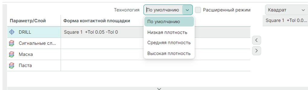
Рис. 57 Выбор плотности монтажа при вводе параметров контактной
