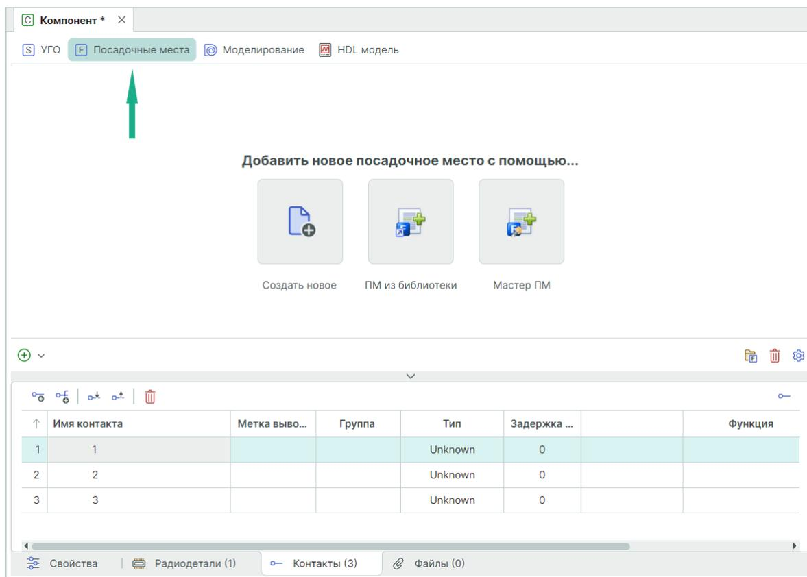
Рис. 253 Способы создания посадочного места
