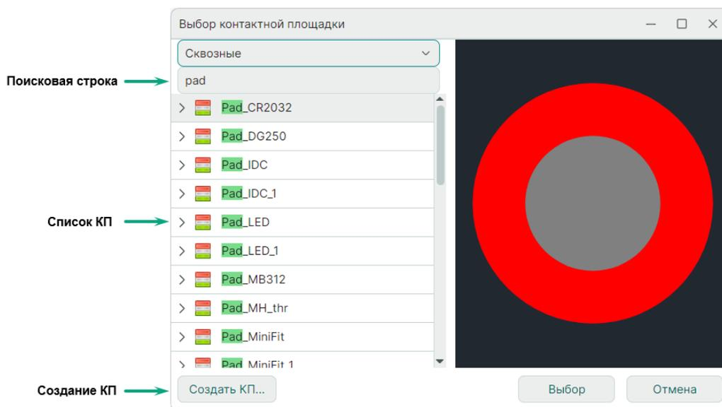
Рис. 86 Выбор размещаемой контактной площадки
