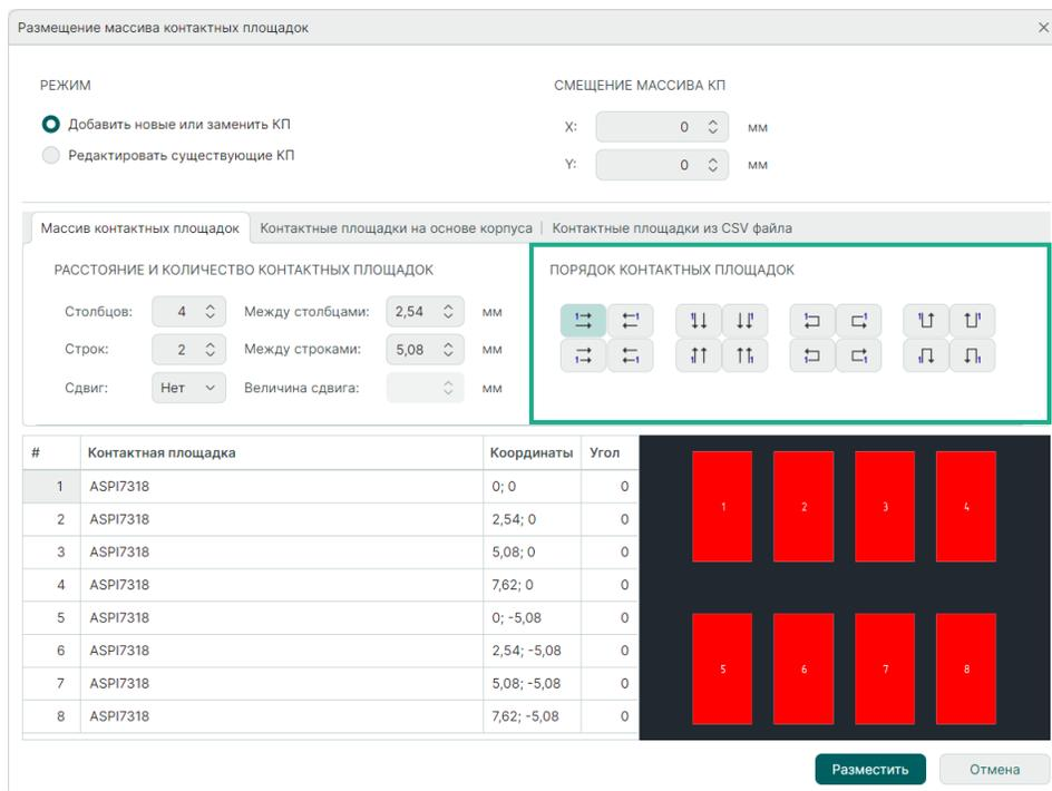
Рис. 95 Порядок нумерации контактных площадок
