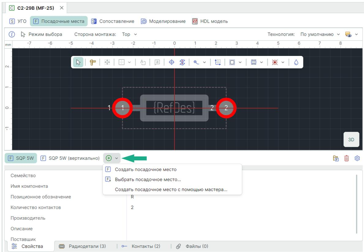
Рис. 256 Варианты создания последующих посадочных мест
