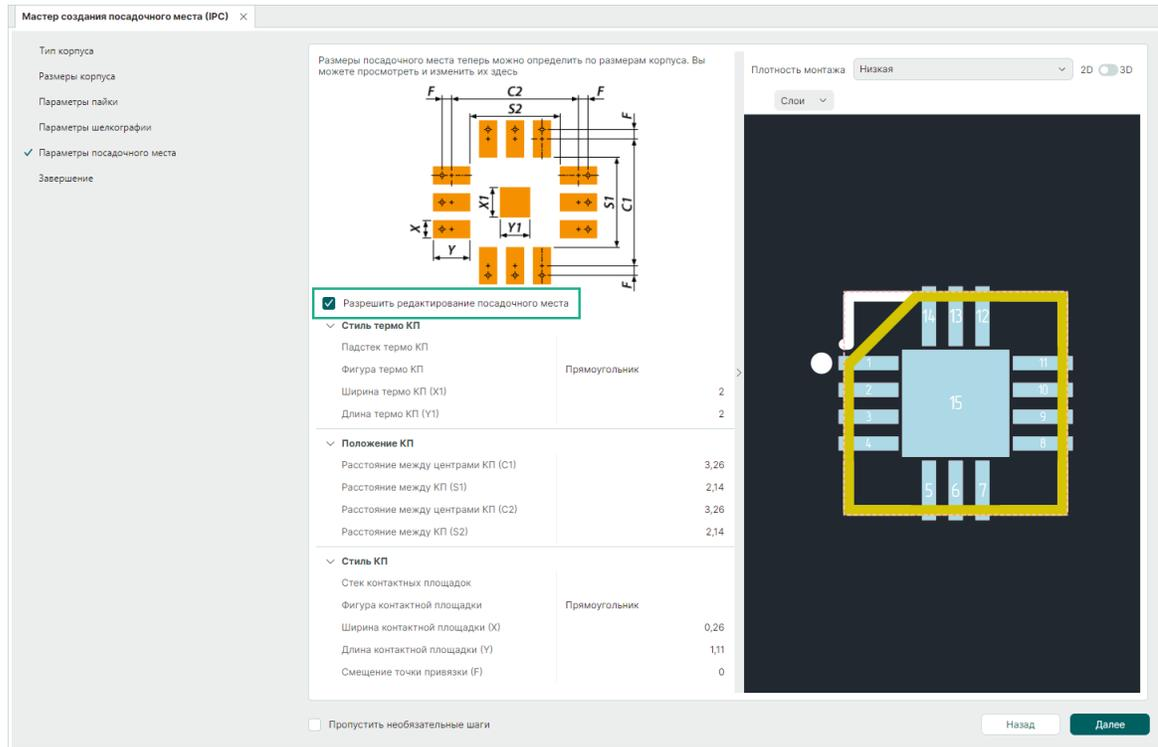
Рис. 158 Уточнение параметров посадочного места
