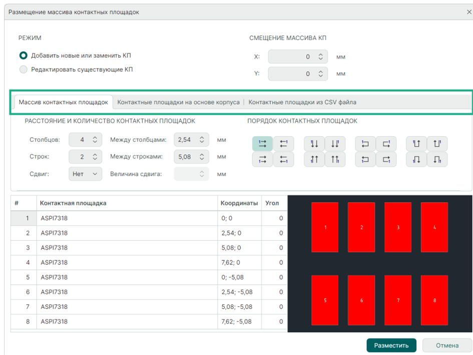
Рис. 94 Выбор варианта создания массива контактных площадок
