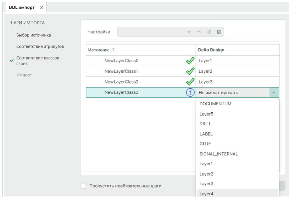
Рис. 26 Сопоставление классов слоев при импорте библиотеки
