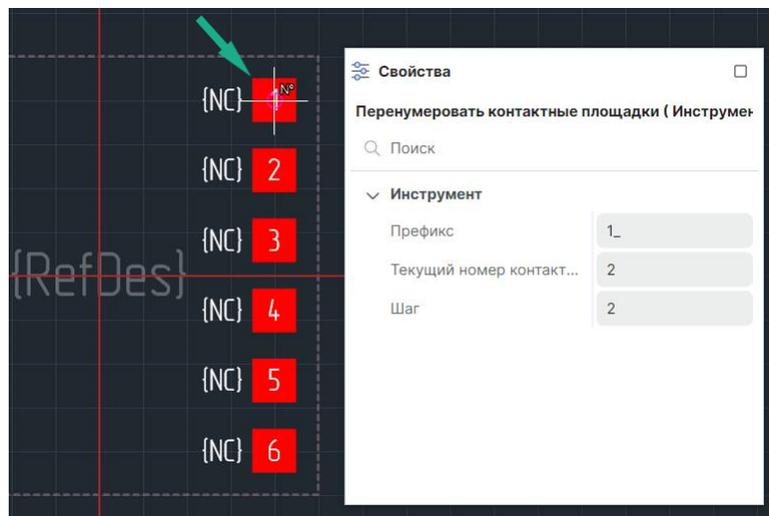
Рис. 144 Параметры инструмента «Перенумеровать контактные площадки»
