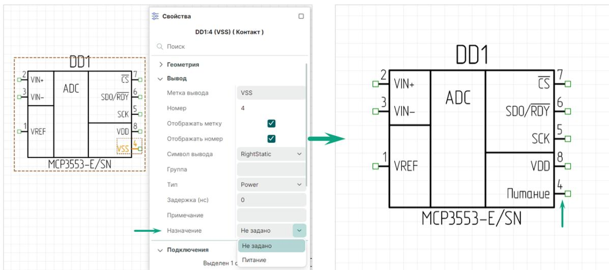
Рис. 273 Выбор назначения в панели "Свойства"
