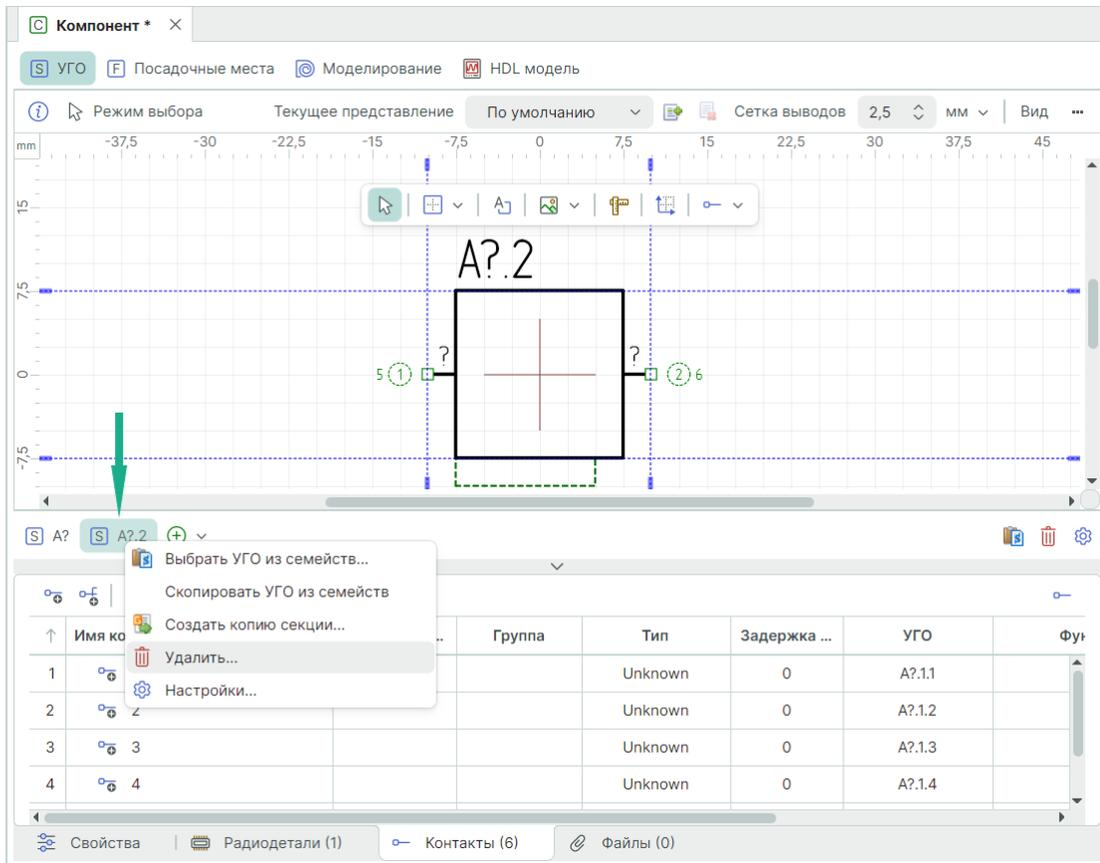
Рис. 221 Удаление секции
