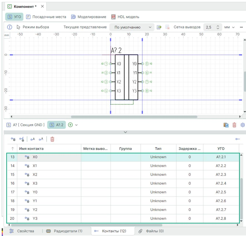
Рис. 238 УГО, созданное с помощью мастера создания УГО
