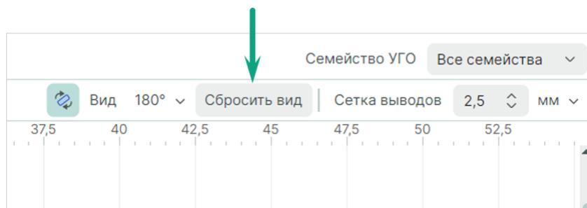
Рис. 199 Сброс отображения УГО до базового
