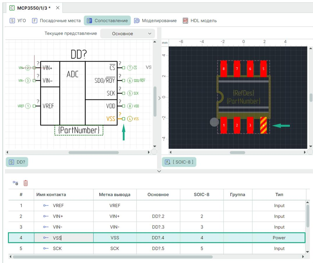
Рис. 281 Сопоставленные выводы и контактные площадки
