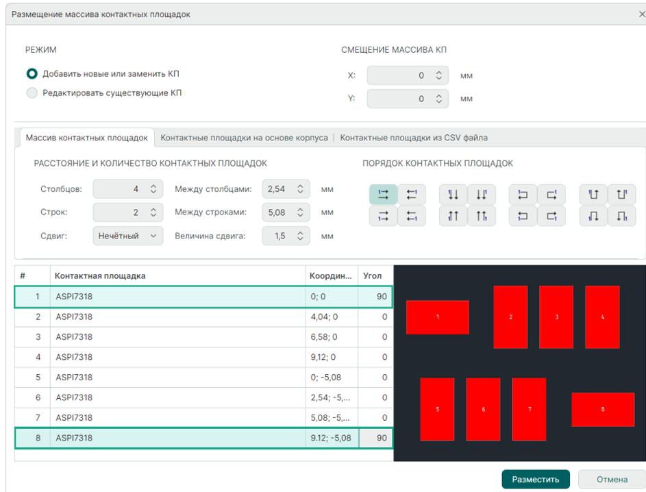
Рис. 101 Индивидуальные координаты и углы поворота контактных площадок
