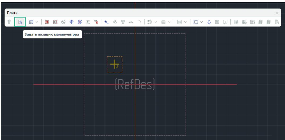
Рис. 114 Установка позиции манипулятора
