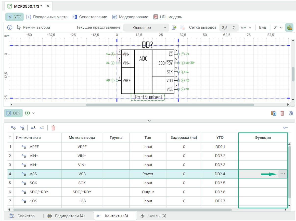
Рис. 270 Определение функции
