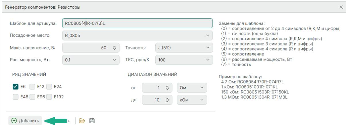
Рис. 318 Добавление шаблона создания радиодеталей
