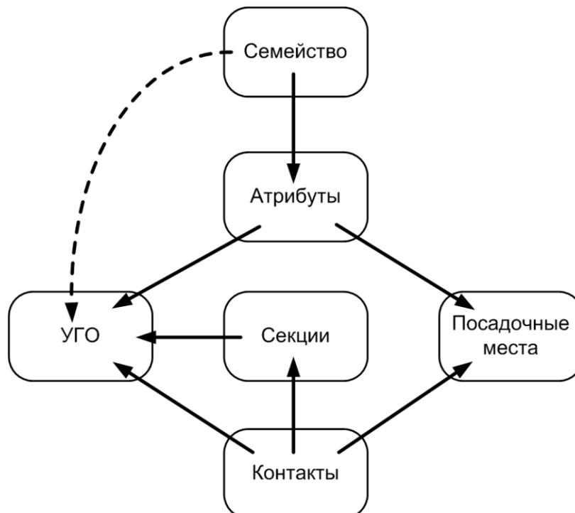
Рис. 200 Схема структуры компонента
