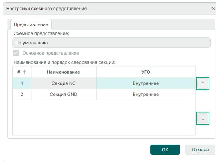
Рис. 229 Изменение порядка отображения секции
