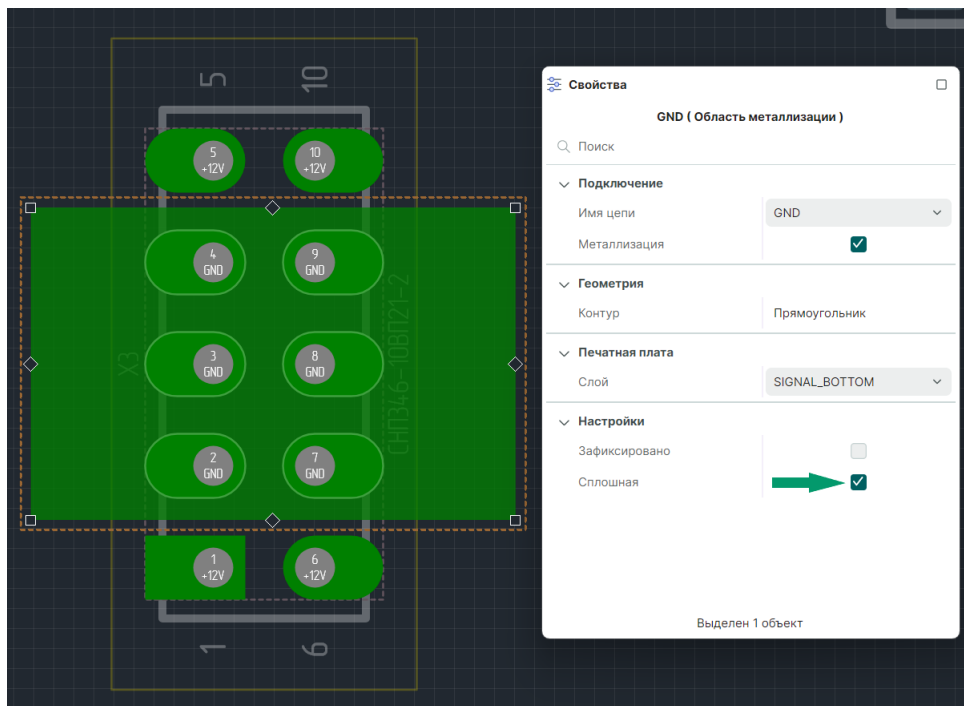
Рис. 436 Сплошная заливка области металлизации
