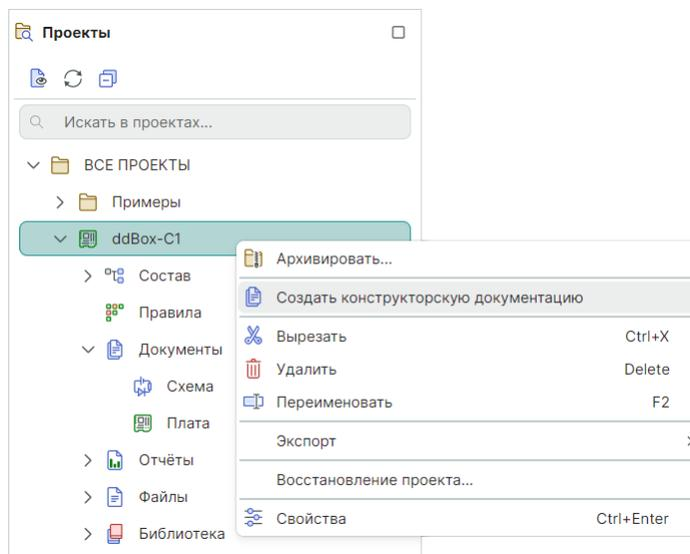
*Рис. 1 Вызов мастера создания конструкторской документации*
