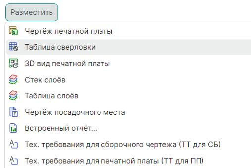
Рис. 98 Переход к размещению таблицы сверловки
