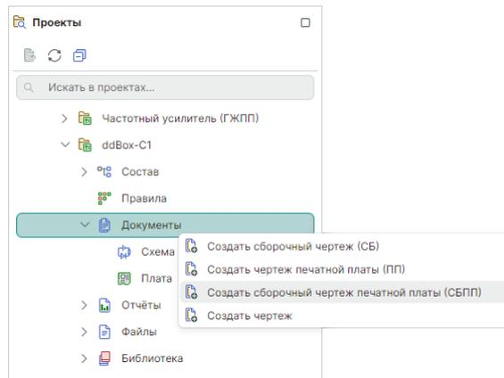
Рис. 73 Переход к созданию сборочного чертежа печатной платы
