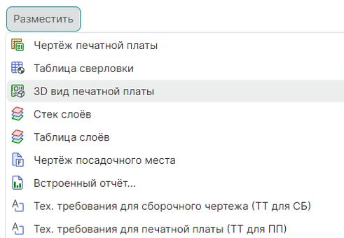
Рис. 106 Вызов инструмента размещения 3D-вида печатной платы
