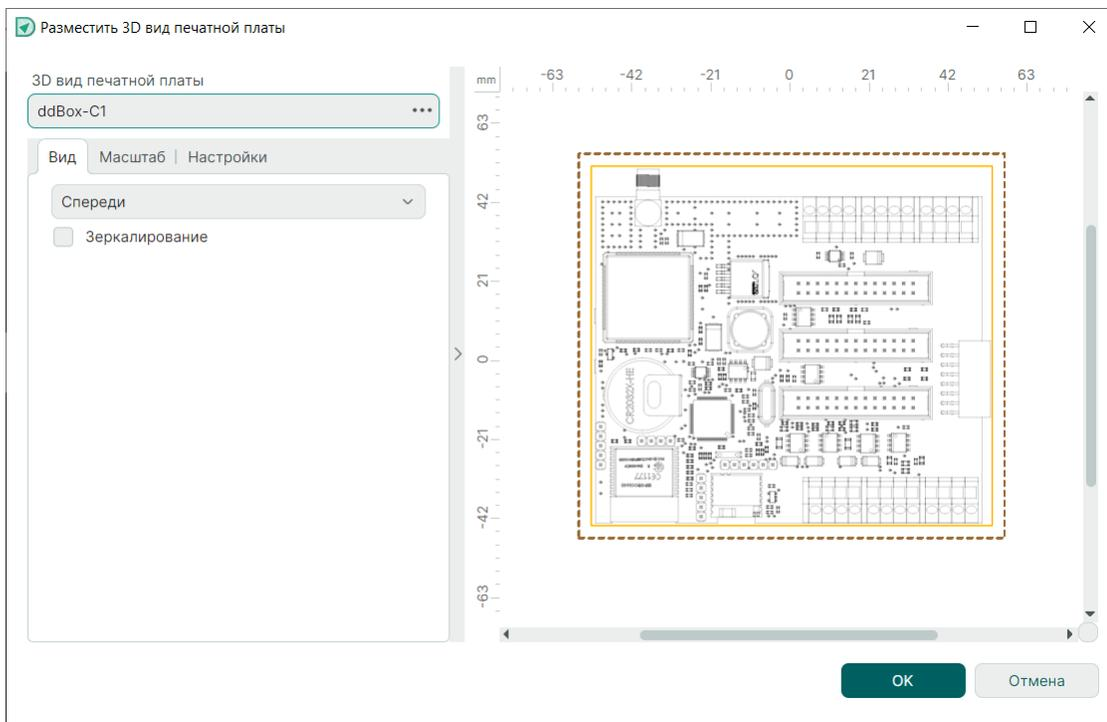
Рис. 107 Окно настроек размещаемого 3D вида печатной платы
