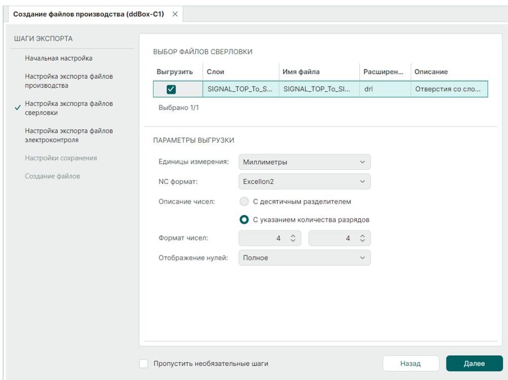
Рис. 153 Настройка экспорта файлов сверловки
