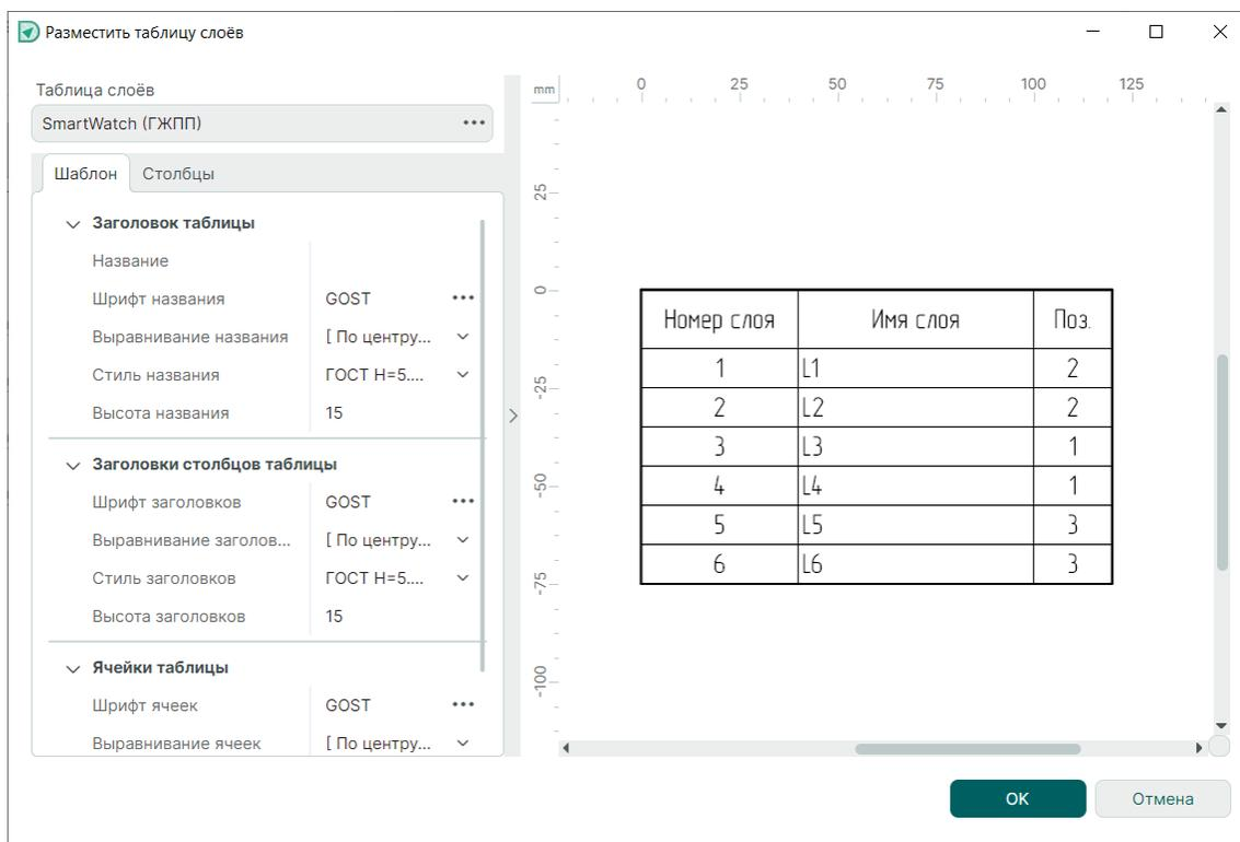
Рис. 113 Окно настроек размещаемой таблицы слоёв
