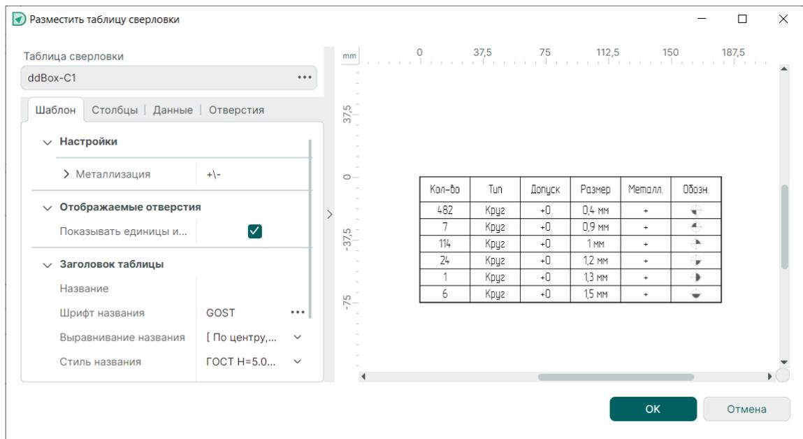
Рис. 99 Окно настроек размещаемой таблицы сверловки
