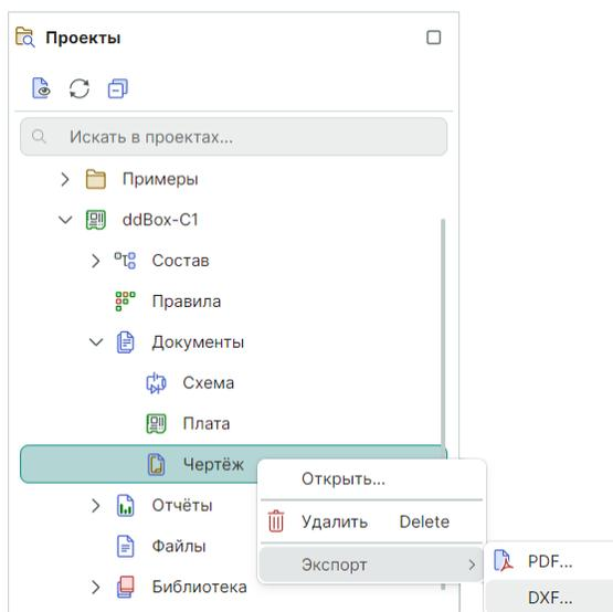
Рис. 128 Вызов экспорта чертежа в формате .DXF
