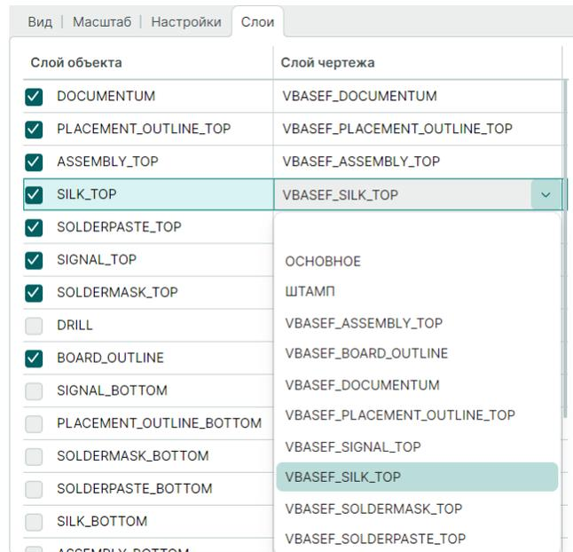
Рис. 97 Настройка отображения слоев при размещении второго и последующих чертежей платы
