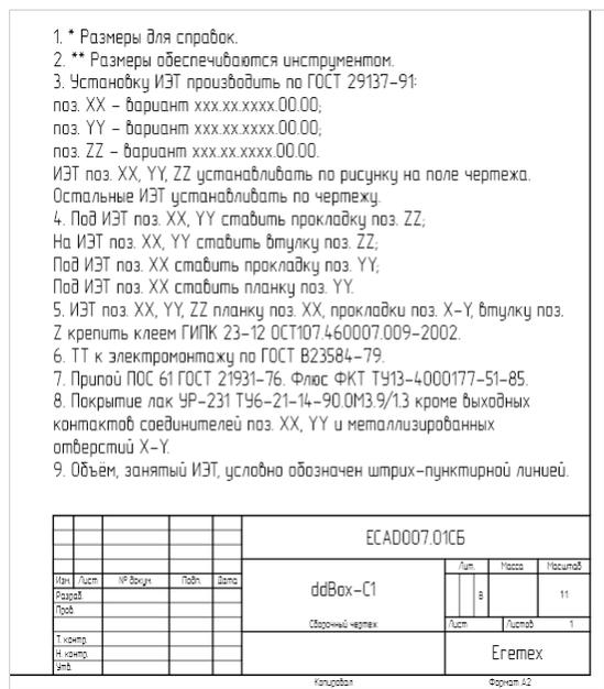
*Рис. 126 Автоматическое расположение технических требований*
