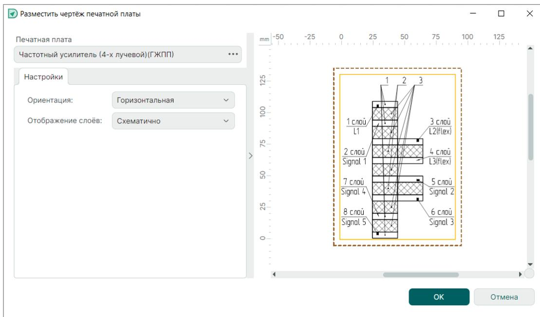
Рис. 109 Окно настроек размещаемого стека слоев
