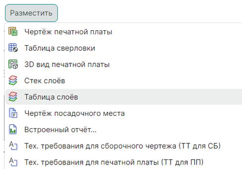
Рис. 112 Переход к размещению таблицы слоев
