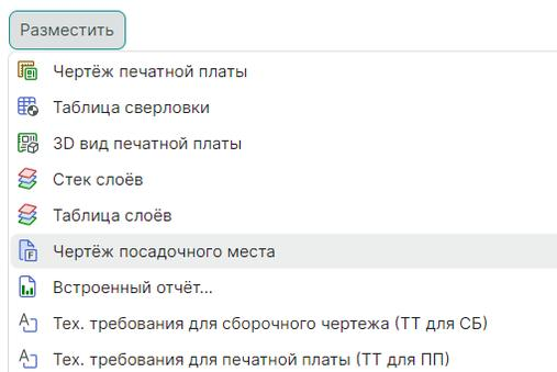
*Рис. 116 Вызов инструмента размещения чертежа посадочного места*
