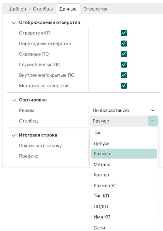
Рис. 102 Данные таблицы сверловки
