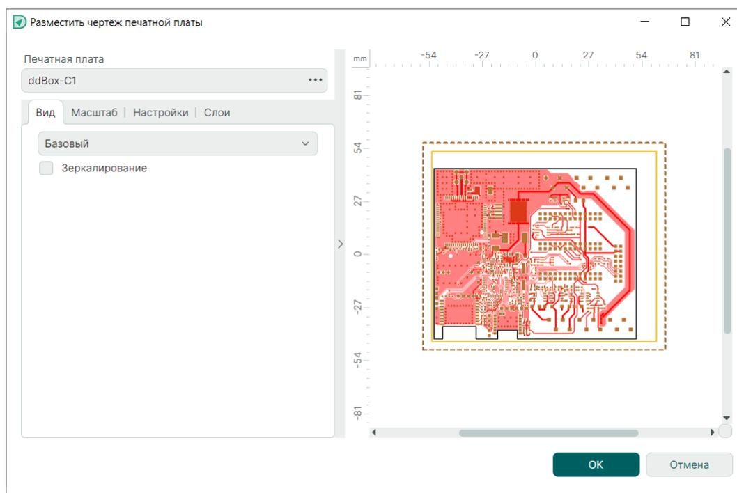
*Рис. 89 Окно настроек для размещаемого чертежа печатной платы*
