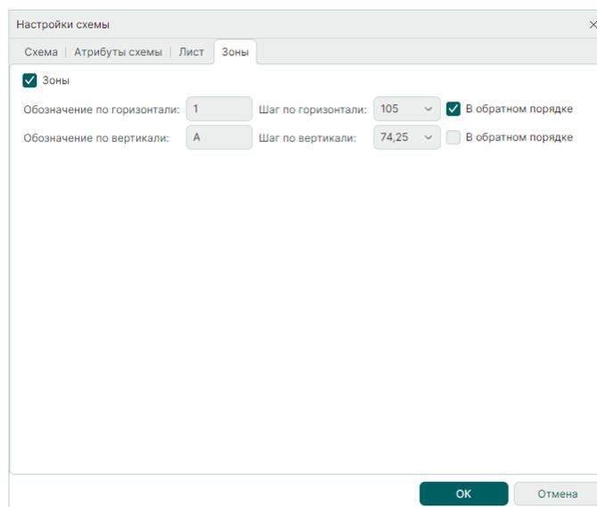
Рис. 42 Параметры разбиения схемы на зоны
