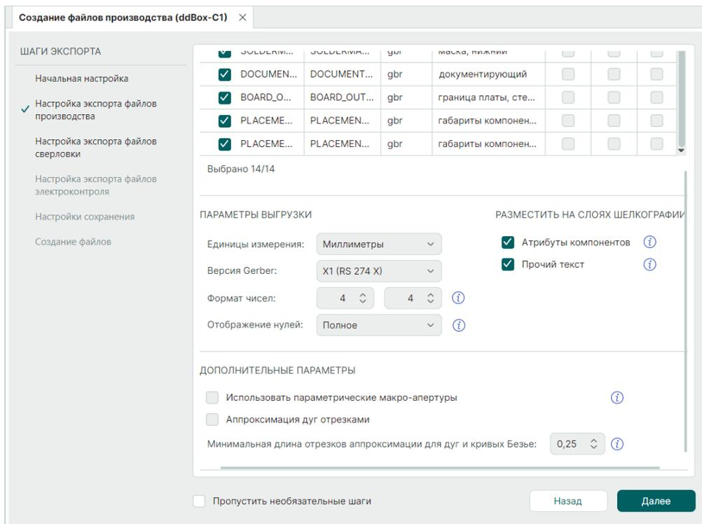
Рис. 151 Настройка экспорта файлов производства
