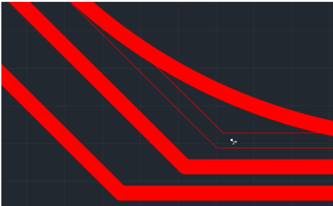
Рис. 3 Отображение (допустимого) скругления вершины трека
