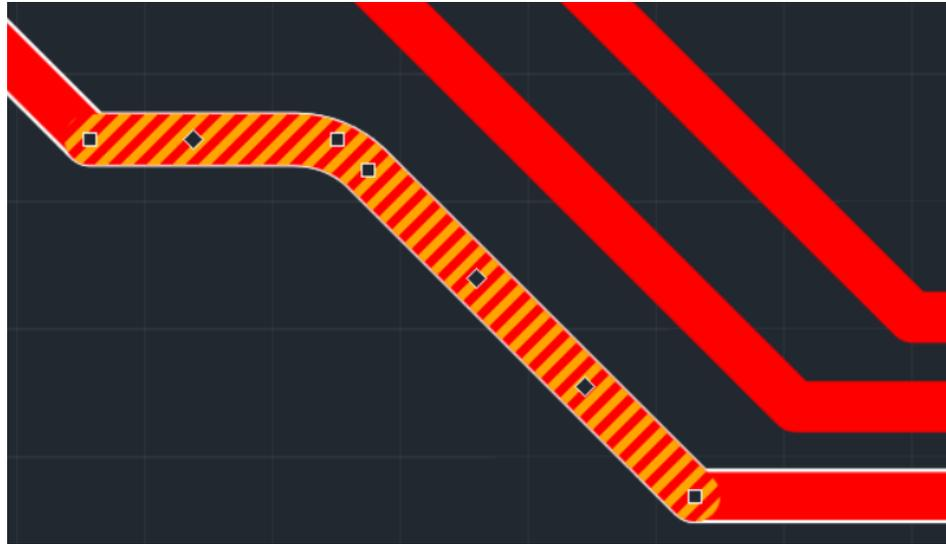
Рис. 9 Отображение примененного скругления в вершине между выбранными смежными сегментами
