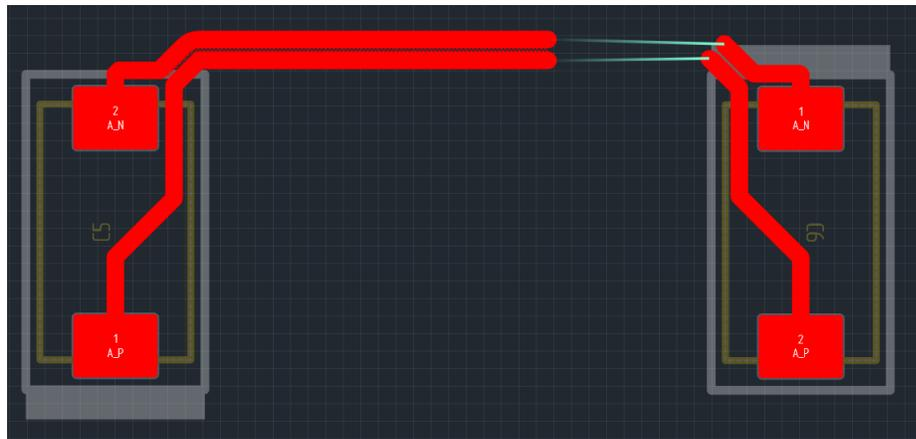
Рис. 340 Соединение двух участков диффпары
