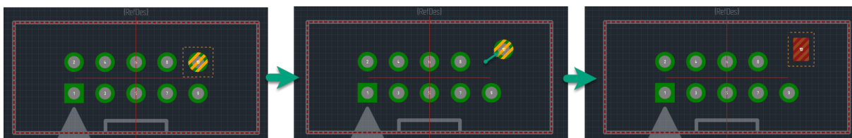
Рис. 55 Смещение при замене контактной площадки
