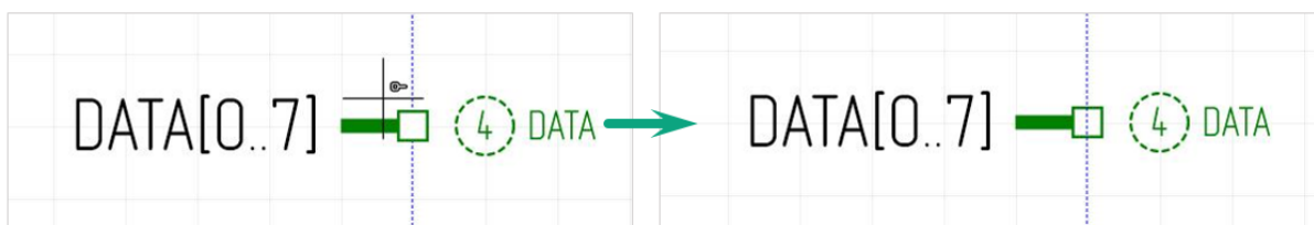
Рис. 241 Размещение группового вывода
