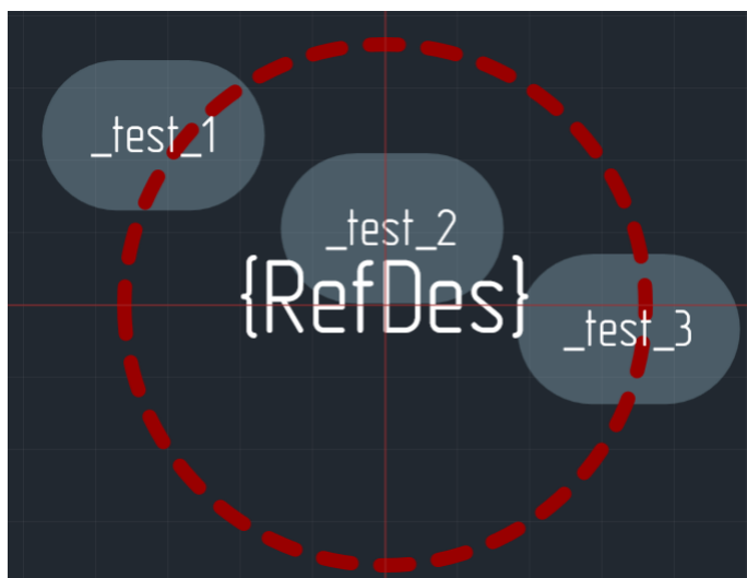
Рис. 144 Перенумерация вдоль линии
