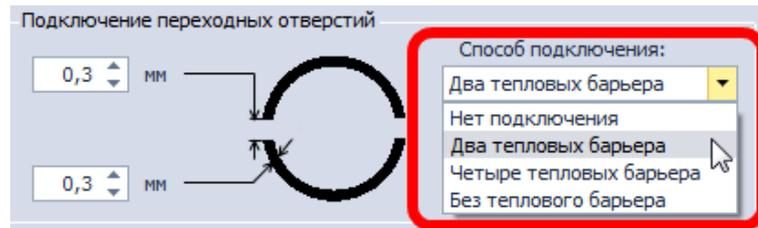
Рис. 140. Способы подключения термобарьеров
