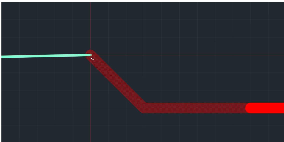
Рис. 37. Измененная комбинация отрезков, при соединении двух точек треком
