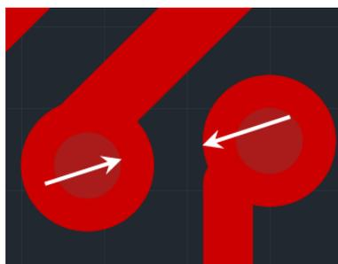
Рис. 211. Зазор между переходным отверстием и любым другим отверстием
