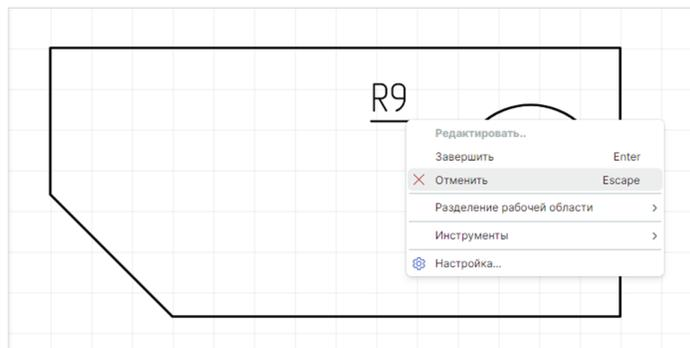
Рис. 178 Отмена размещения размерной линии
