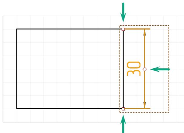
Рис. 171 Точки редактирования вертикальной размерной линии
