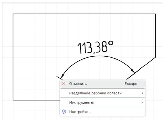
Рис. 173 Отмена размещения размерной линии
