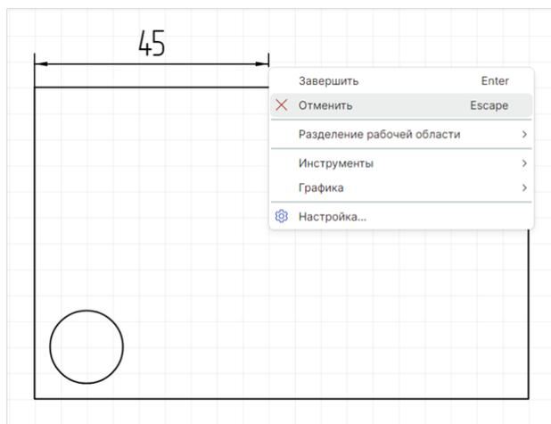
Рис. 167 Отмена размещения размерной линии
