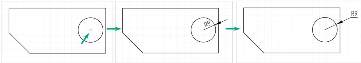
Рис. 176 Размещение радиальной размерной линии
