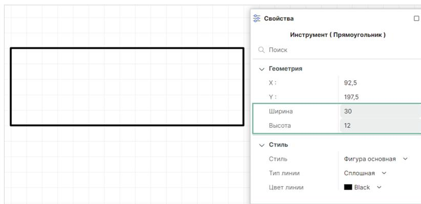
Рис. 37 Ввод значений в панель «Свойства»
