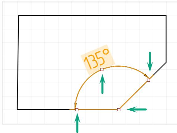
Рис. 174 Точки редактирования угловой размерной линии
