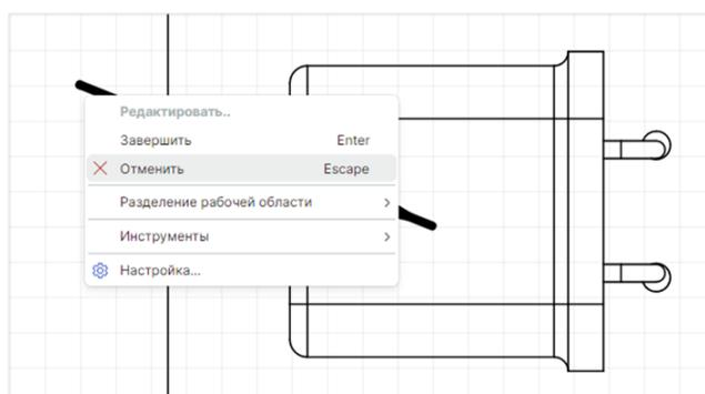
Рис. 187 Отмена размещения размерной линии
