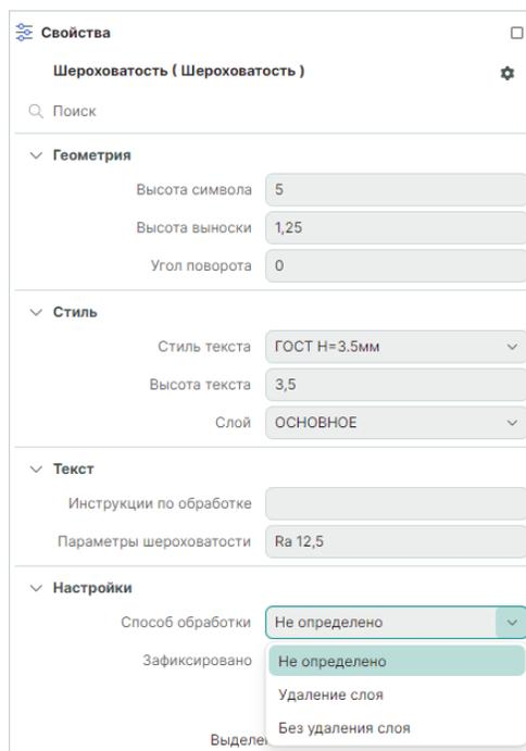
Рис. 193 Свойства обозначения шероховатости
