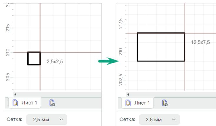
Рис. 137 Привязка к сетке. Шаг сетки 2,5 мм
