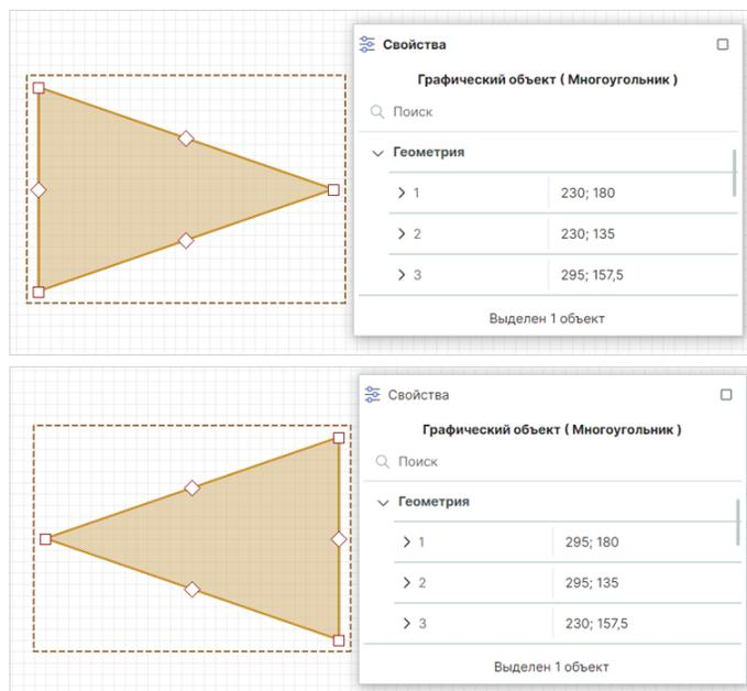
Рис. 108 Зеркальное отражение объекта относительно выбранной оси
