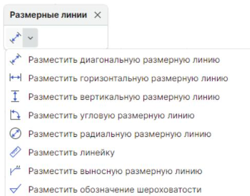
Рис. 151 Панель инструментов «Размерные линии»
