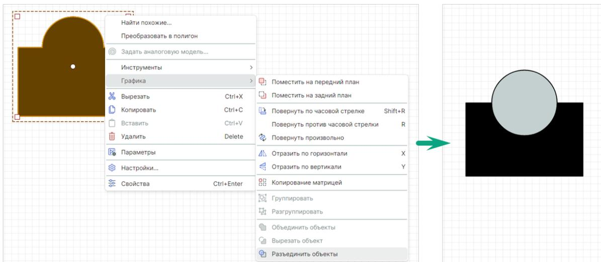
Рис. 118 Разъединение объектов
