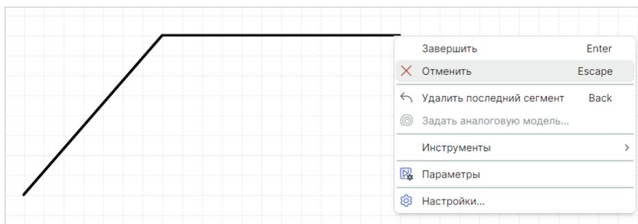
Рис. 22 Отмена построения линии
