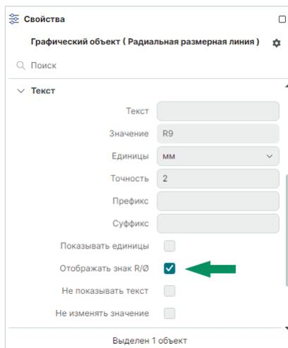
Рис. 180 Свойства радиальной размерной линии
