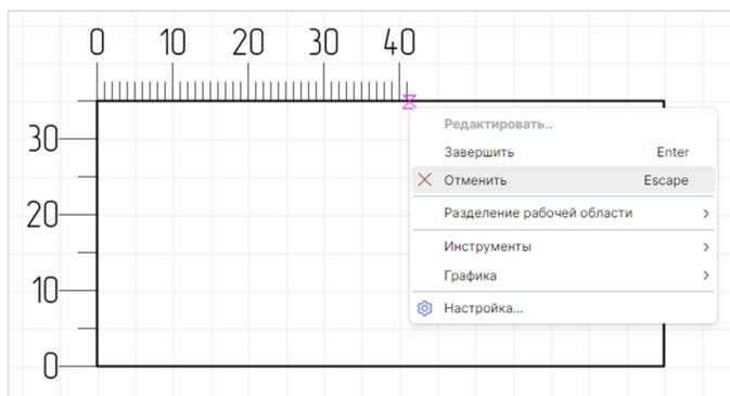
Рис. 182 Отмена размещения размерной линии
