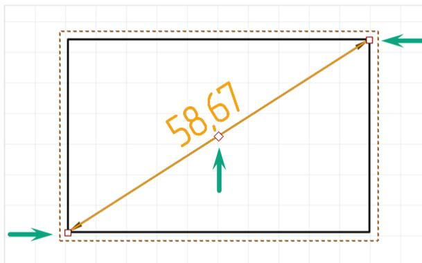
Рис. 156 Точки редактирования диагональной размерной линии
