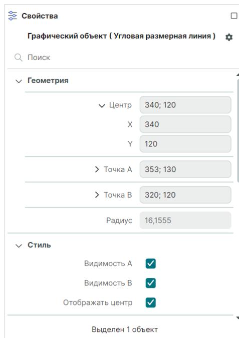
Рис. 175 Свойства угловой размерной линии
