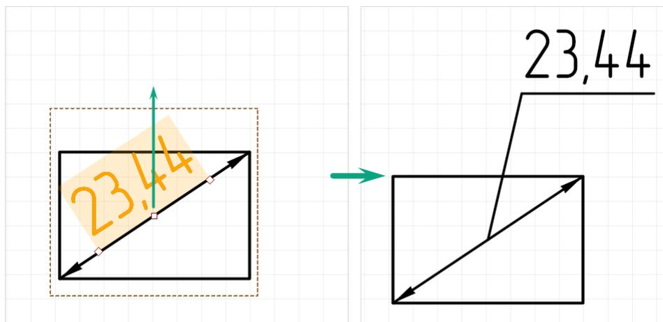
Рис. 157 Размещение текста на размерной полке
