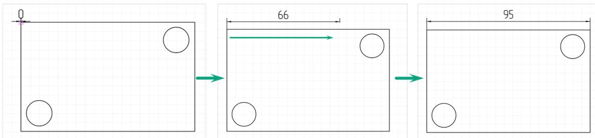
Рис. 166 Размещение горизонтальной размерной линии
