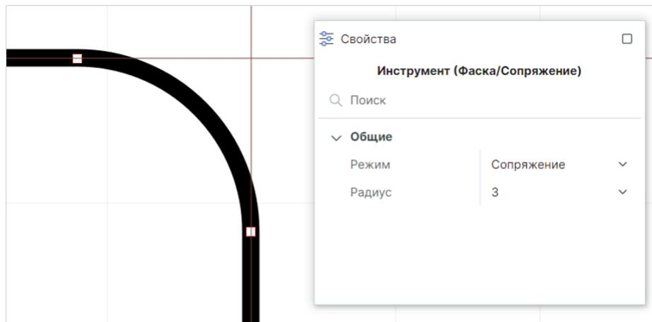
Рис. 71 Свойства сопряжения в панели «Свойства»
