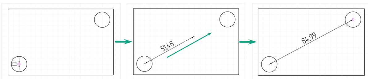
Рис. 154 Размещение диагональной размерной линии
