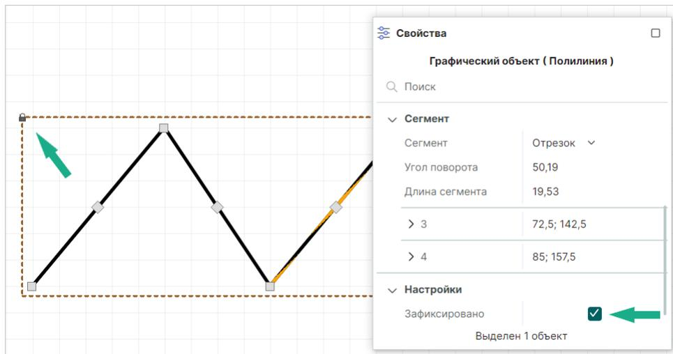
Рис. 27 Фиксация линии
