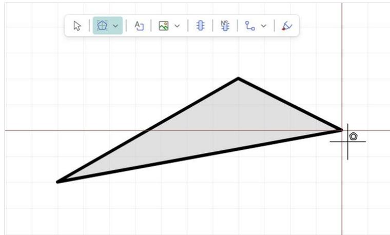
Рис. 41 Фиксация размещения первой стороны многоугольника
