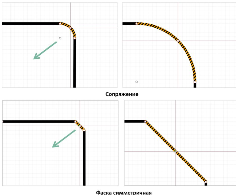
Рис. 79 Точки редактирования сопряжения и симметричной фаски
