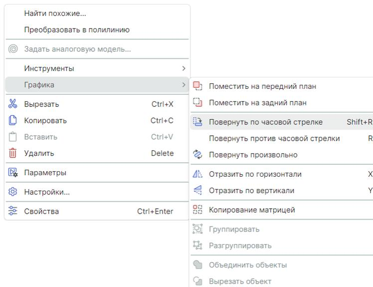
Рис. 109 Поворот объекта по часовой стрелке на угол, кратный 90°
