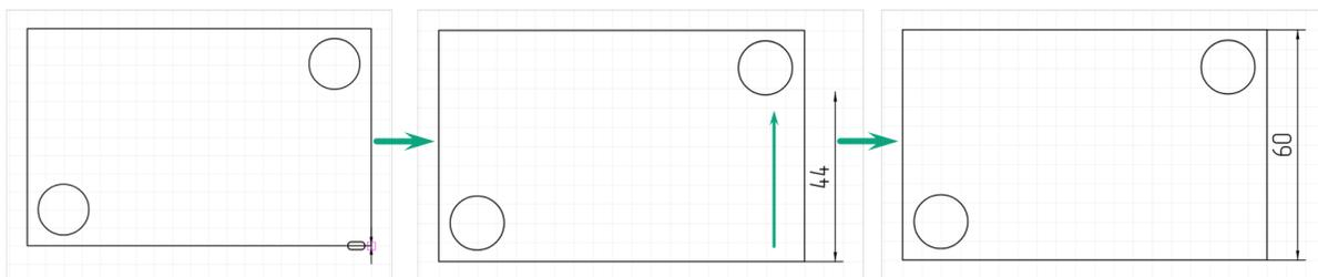
Рис. 169 Размещение вертикальной размерной линии
