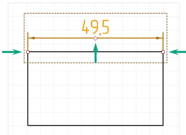
Рис. 168 Точки редактирования горизонтальной размерной линии
