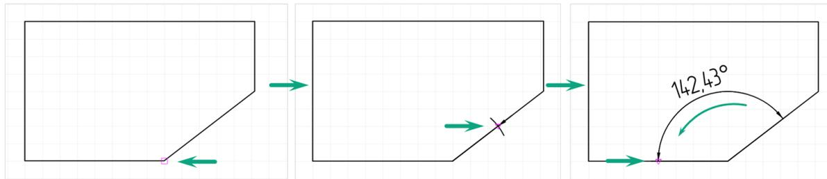
Рис. 172 Размещение угловой размерной линии
