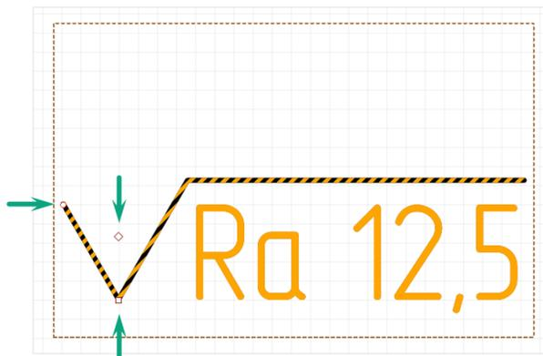
Рис. 192 Точки редактирования обозначения шероховатости
