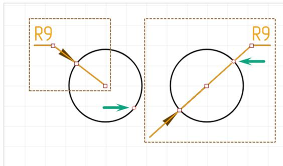
Рис. 179 Точки редактирования радиальной размерной линии
