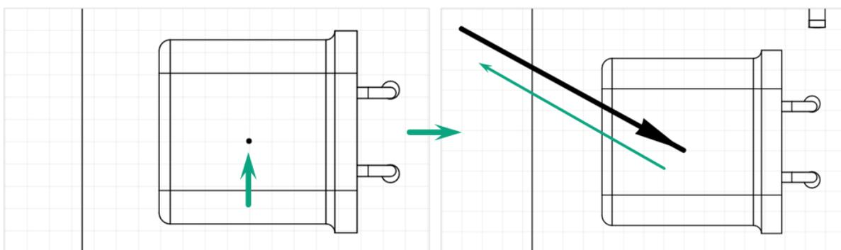
Рис. 186 Размещение выносной линии
