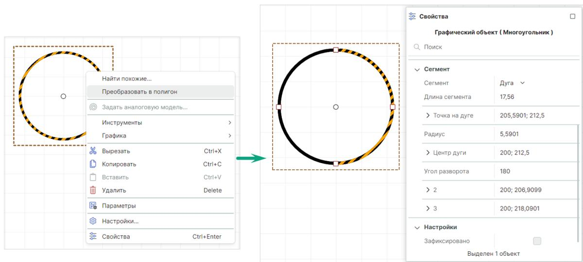
Рис. 51 Преобразование окружности
