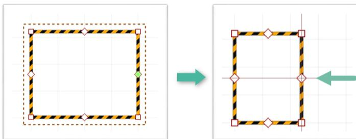
Рис. 13 Изменение геометрии объекта через точки редактирования
