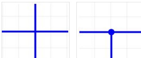
Рис. 66 Пересечение и объединение цепей на схеме
