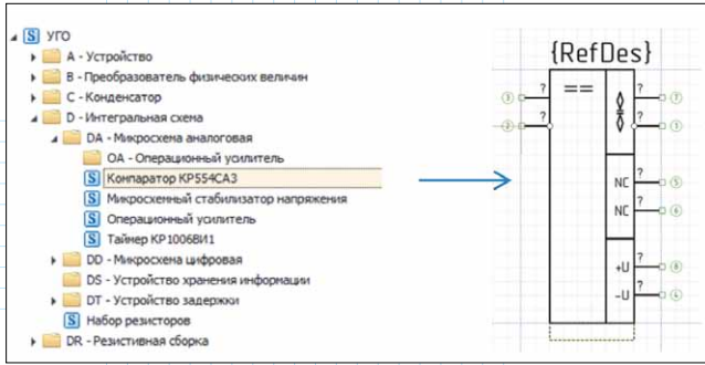
Рис. 27. УГО: широкий набор условных графических обозначений электронных компонентов, соответствующих требованиям ГОСТов и доступных при разработке библиотек компонентов
