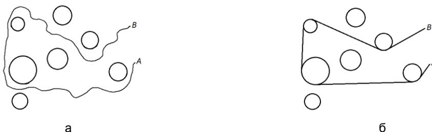
Рис. 1. Натянутая нить огибает колонны по дугам окружностей: нить путника (а); натянутая нить путника (б)
