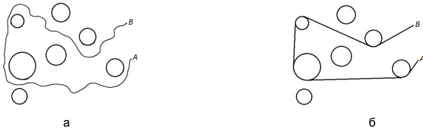
Рис. 1. Натянутая нить огибает колонны по дугам окружностей: нить путника (а); натянутая нить путника (б)
